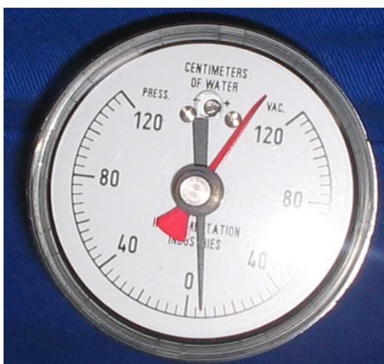
FIGURA 10 – Manovacúmetro utilizado para a mensuração da Pressão Inspiratória Máxima e Pressão Expiratória Máxima
