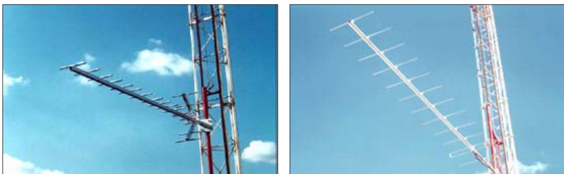
Figura 3.8 – Antena Yagi para transmissão em UHF e VHF (Ideal Antenas Profissionais)
