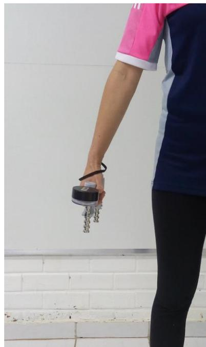
FIGURA 08: Teste de força por dinamômetro hidráulico manual.
