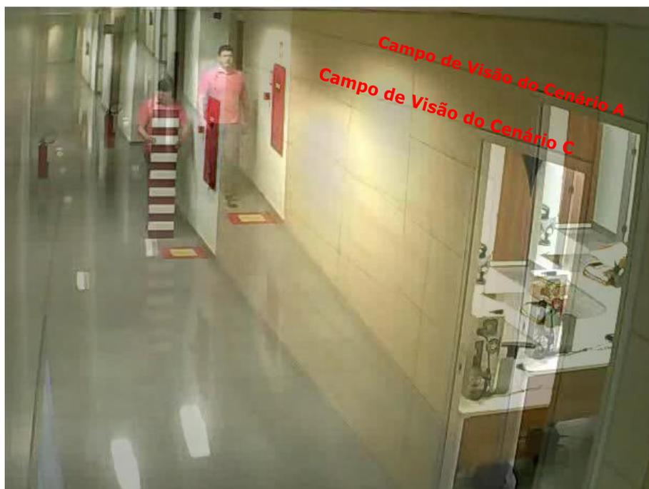
Figura 4.7. Comparação entre o campo de visão do cenário A, onde foram capturados o alvo e a escala de referência como ESCALA01, e o campo de visão do cenário C, onde a escala de referência foi capturada como ESCALA03.
