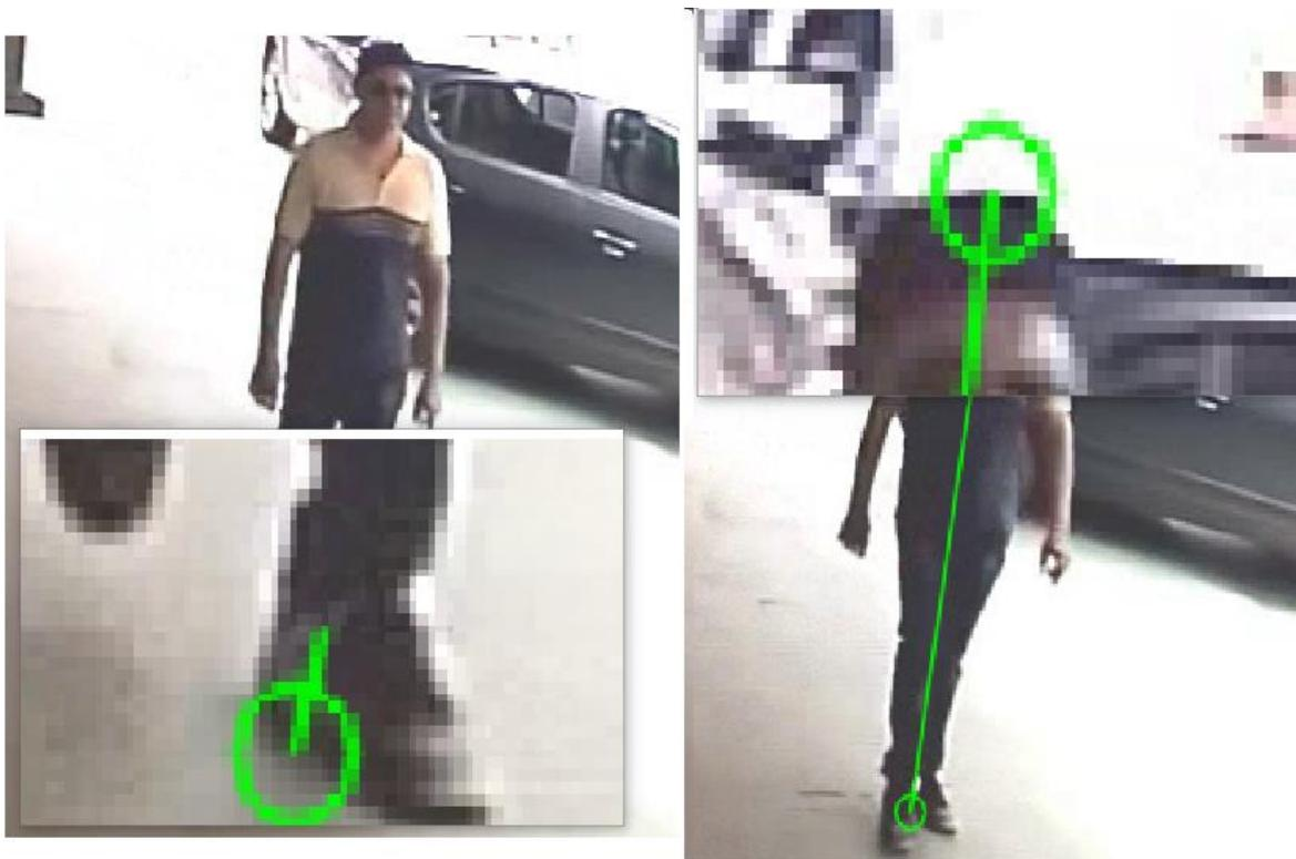
Figura 3.11. Exemplo de marcação de coordenadas de alvo utilizando a ferramenta de acessibilidade “lupa” dos sistemas operacionais da Microsoft (2016).
