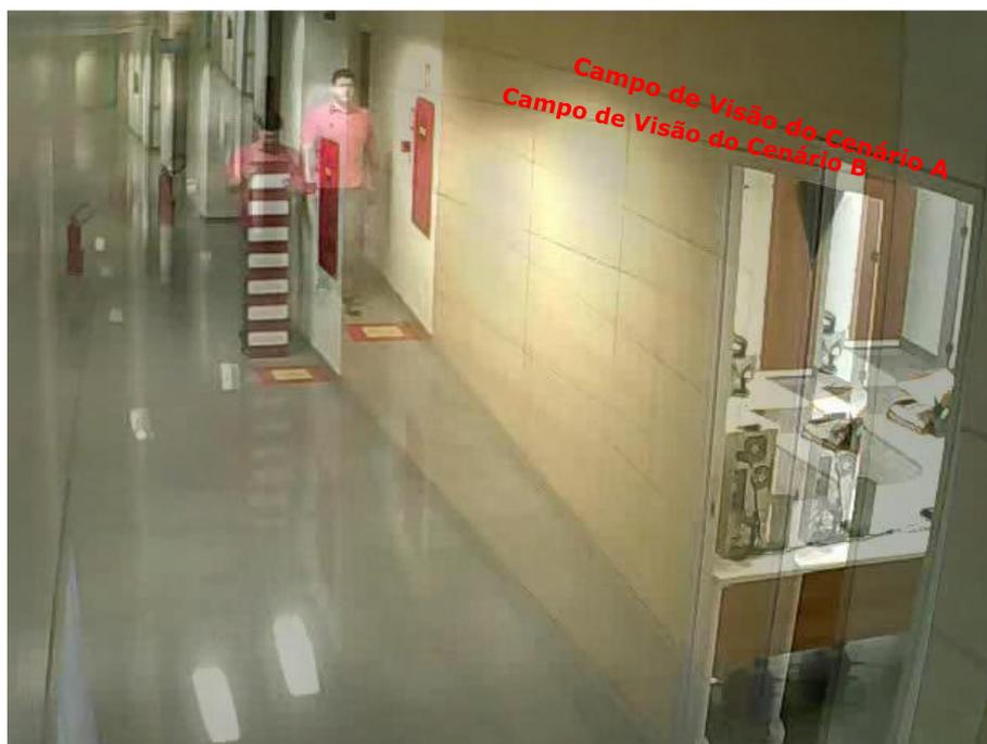
Figura 4.6. Comparação entre o campo de visão do cenário A, onde foram capturados o alvo e a escala de referência como ESCALA01, e o campo de visão do cenário B, onde a escala de referência foi capturada como ESCALA02.
