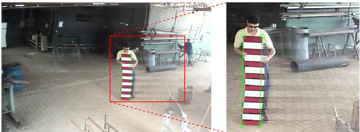
Figura 4.12. À esquerda, um quadro de vídeo produzido pela câmera Cam13. À direita, e um recorte ampliado do mesmo quadro. Observa-se a continuidade das faixas da escala no quadro.
