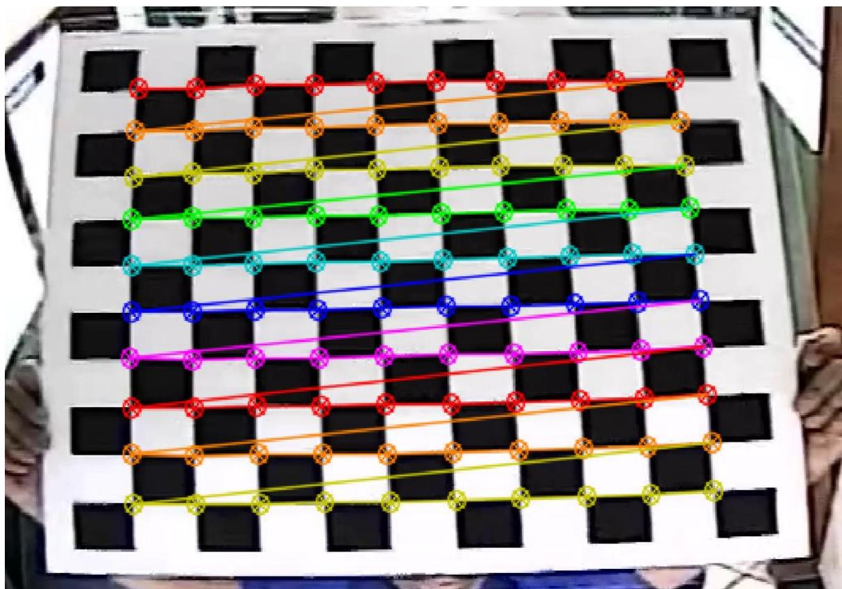
Figura 3.2. Exemplo de detecção dos cantos internos do padrão de calibração.
