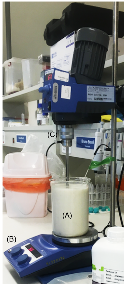
Figura 8. Sistema reacional utilizado para as hidrólises enzimáticas do amido presente no arroz comercial e no arroz gigante BRS AG. Onde: (A) béquer com a mistura reacional (arroz previamente moído e tampão citrato de sódio), (B) placa de aquecimento, (C) homogeneizador.
