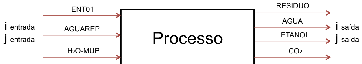
Figura 29. Esquema simplificado do processo contínuo de produção de etanol utilizando arroz comercial e arroz gigante como matéria-prima.
