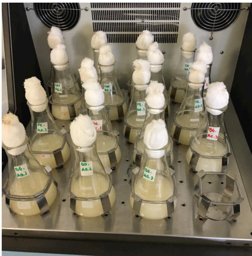
Figura 11. Sistema utilizado para as reações de fermentação com as diferentes linhagens da levedura Saccharomyces cerevisiae .
