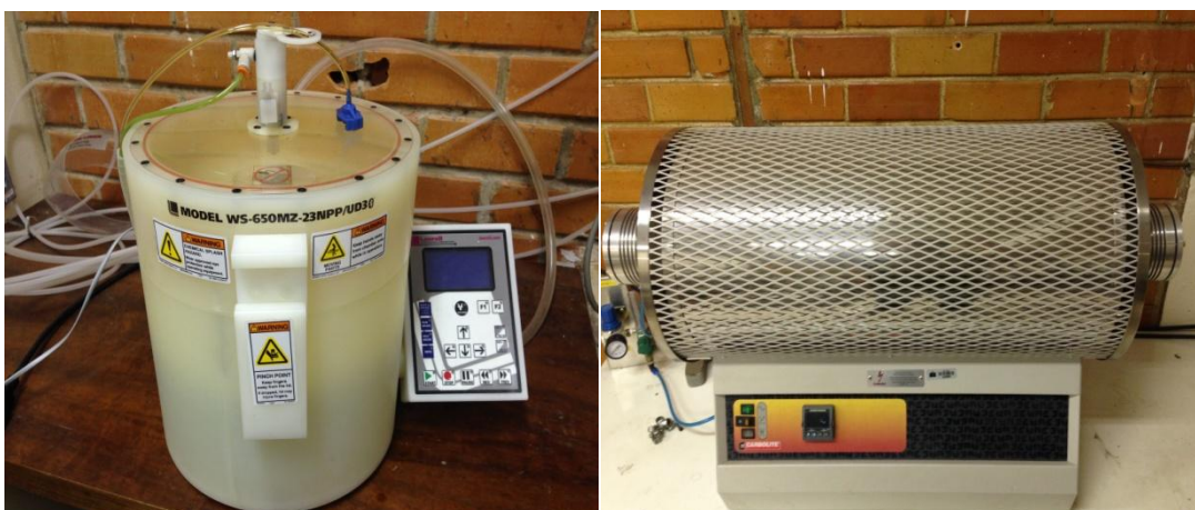
Figura 3.8: a) Spin-coater da marca Laurell, modelo WS-650MZ-23NPP utilizado na deposição do filme de \text{CuInS}_2 em substrato de vidro coberto com partículas de ouro (Au). b) Forno tubular da marca Carbolite utilizado na calcinação do filme de \text{CuInS}_2 sob atmosfera inerte de argônio (Ar).
