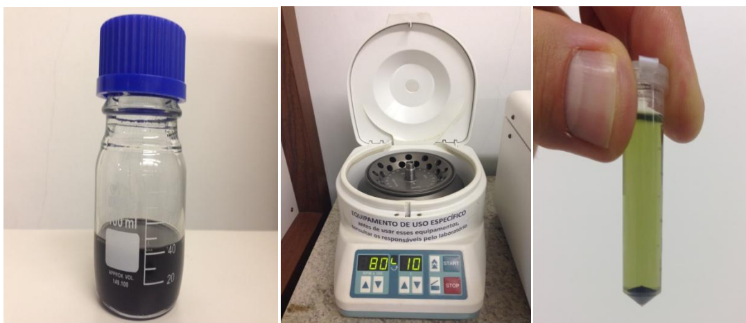
Figura 3.4: (a) Solução metálica de nanocristais de \text{CuIn}(\text{S}_{0,5}\text{Se}_{0,5})_2 (calcopirita) em oleilamina após a síntese. (b) Centrifuga. (c) Eppendorf contendo oleilamina na parte superior e nanocristais precipitados na parte inferior.
