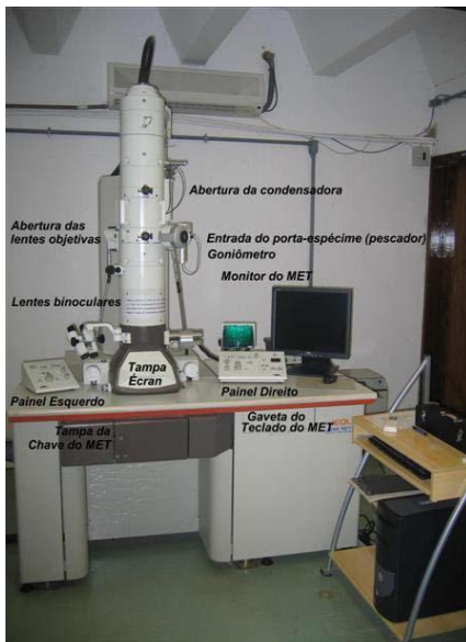
Figura 3.12: a) Microscópio eletrônico de transmissão (MET), marca JEOL JEM 1011. b) Sinais produzidos pelo espécimen sob irradiação do feixe de elétrons. Fonte: Bão (2008) [87].
