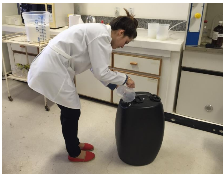
Figura 11. O experimento piloto de 20 L de LBN com tanino, bórax, LESS e KOH permaneceu em observação por mais de 50 dias, sem deteriorar ou coagular.
