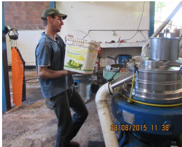
Figura 12. O experimento piloto de 20 L de látex foi processado em centrífuga industrial na Usina Jasmim, (S.J. do Rio Preto/SP), e suportou bem a alta taxa de cisalhamento do processo. O operador Carlos Rossi gravou depoimento de que o látex experimental estava igual ao do látex normal.
