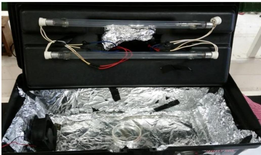
**Figura 16.** Imagem da câmara para redução fotoquímica.
