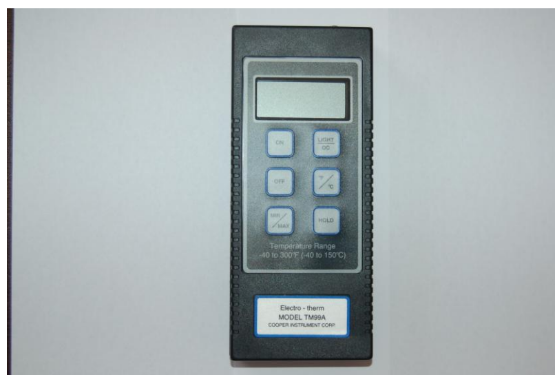
Figura 8: Aparelho termômetro digital para medir a temperatura da mão. Modelo ELECTRO-THERM DIGITAL THERMOMETER mod. TM99A . Propriedade do pesquisador.
