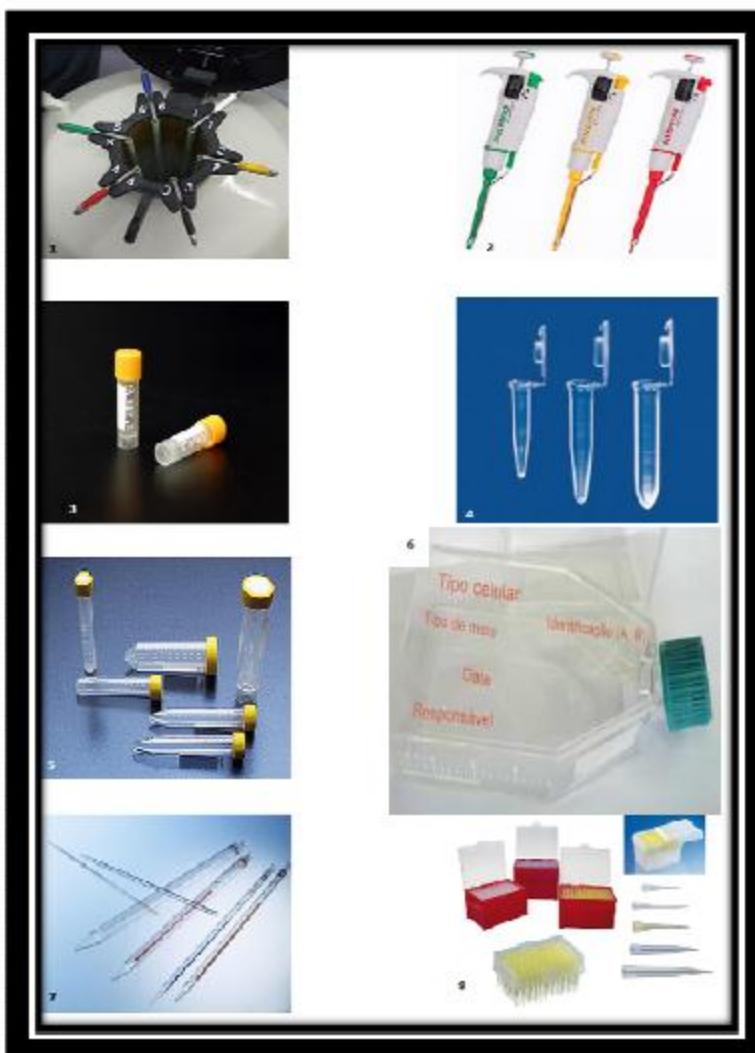
Figura 4.2. Equipamentos e plásticos utilizados em cultivo celular. 1- Botijão de Nitrogênio Líquido. 2- Pipetas automáticas. 3- Criotubos. 4- Garrafa de cultivo celular. 5- Tubos tipo Falcon. 6- Pipetadores manuais. 7- Pipetas sorológicas. 8- Ponteiros. Imagens: provém de divulgação comercial.
