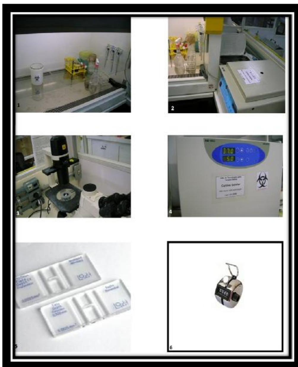
Figura 4.1 Equipamentos básicos utilizados em uma sala de cultivo celular. 1- Fluxo laminar. 2- Centrífuga. 3- Microscópio invertido. 4- Incubadora/estufa de CO 2 . 5- Câmara de Neubauer. 6- Contador de células.
