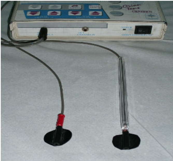
Figura 1.A - Fotografia do primeiro protótipo do eletrodo móvel desenvolvido pela autora utilizando um tubo de uma caneta esferográfica, um cabo de corrente e dois eletrodos de borracha para as pontas.
