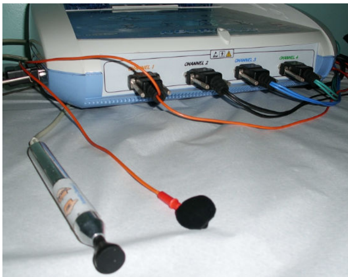
Figura 3.A - Fotografia do terceiro protótipo do eletrodo móvel desenhado pela autora e desenvolvido pelo engenheiro da empresa Ibramed, adaptado ao aparelho Neurodyn Ruby, com botões de controle da intensidade da corrente no corpo do eletrodo e ponteira móvel circular.
