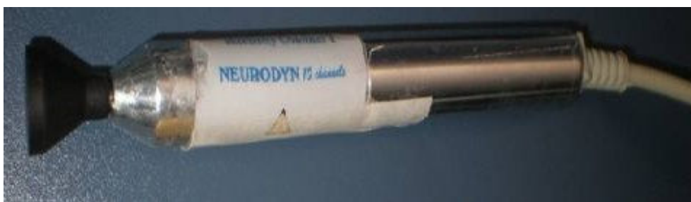
Figura 1.8 - Fotografia do eletrodo caneta adaptado pelo fabricante Ibramed preparada para o protocolo experimental (Fonte: própria autora).
