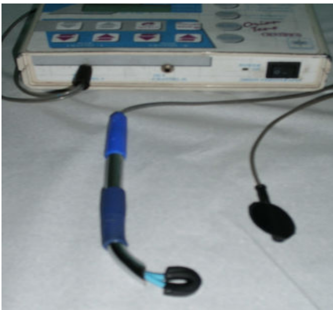
Figura 2.A - Fotografia do segundo protótipo do eletrodo móvel desenvolvido pela autora utilizando um tubo metálico e uma ponta com eletrodo de borracha em “U”.
