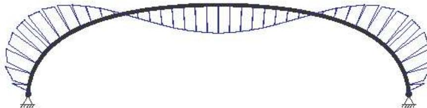
Figura 3.24 – Gráfico do momento fletor da estrutura proposta, a forma arquitetônica seguindo a função estrutural. Fonte: FTOOL (MARTHA, 2002).
