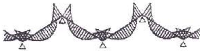
**Figura 3.20** – Momentos de flexão de coberturas plissadas. Fonte: (SANDAKER, 1992).
