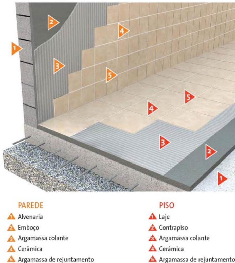
Figura F.1 – Sistema de revestimento em pisos e paredes
