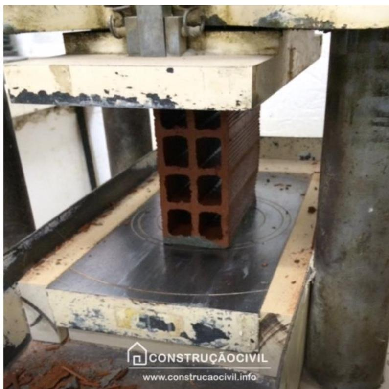
Figura E.9 – Ensaio de resistência à compressão de um bloco cerâmico
