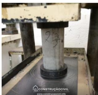
Figura J.8 – Ensaio em concretos de cimento Portland na UnB – ensaio de resistência à compressão do concreto
