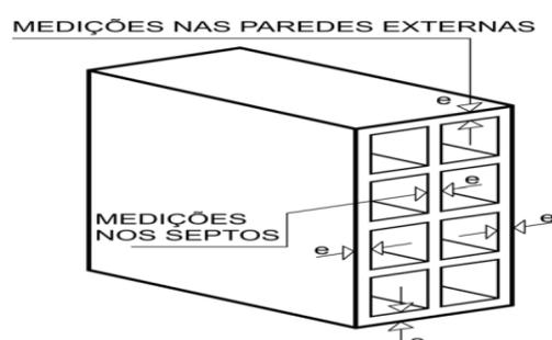
Figura E.4 – Posições esquemáticas para as medições da espessura das paredes externas e septos
