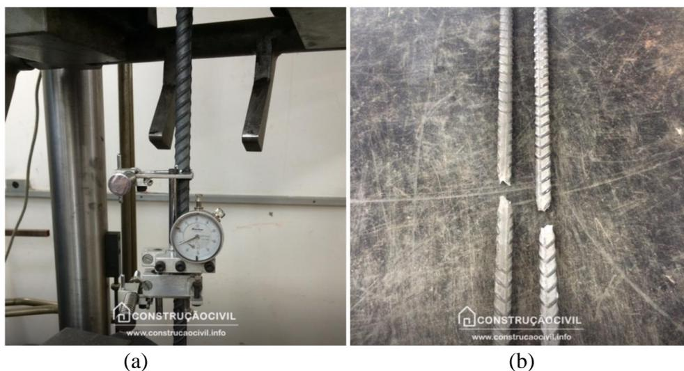
Figura G.5 – Ensaio realizado em vergalhões de aço para concreto armado
