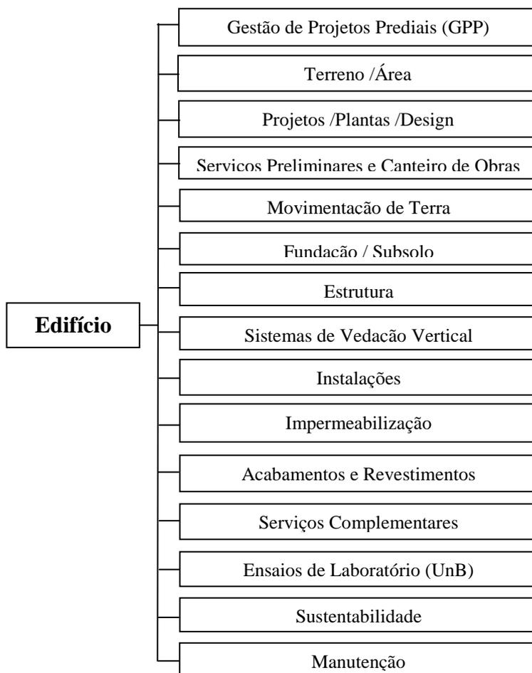
Figura 4.4 – EAP: o passo-a-passo na construção de uma edificação no Brasil (visão sistêmica macro)
