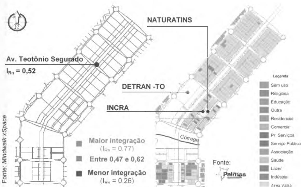
Figura 3.10 - Mapas axial (R<sub>n</sub>) e de tipos de uso do solo da Av. Teotônio Segurado (Norte).
