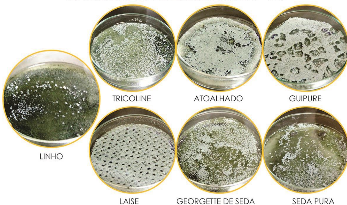
Figura 44. Comparação dos diferentes tecidos crescidos em meio líquido em placa de Petri com o isolado G85, destacando o bom resultado do tingimento no linho.
