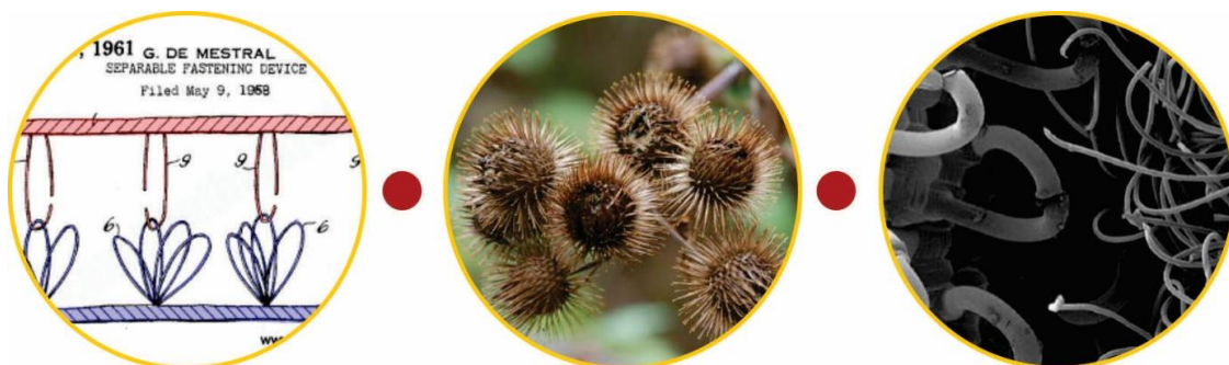
Figura 2. Projeto do velcro de G. de Mestral, fotografia do carrapicho que foi sua fonte de inspiração e foto de uma microscopia eletrônica de varredura de um velcro. (Fonte: http://www.explainthatstuff.com/inventors-and-inventions.html acessado em 23/05/2015)
