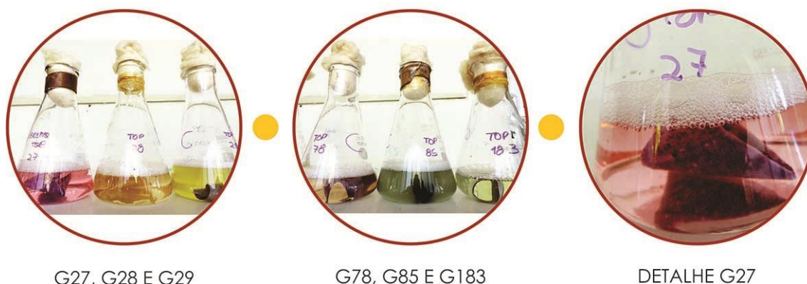
Figura 35. Procedimento de lavagem do tecido no experimento TOP, caracterizando a perda de cor do tecido para a água.
