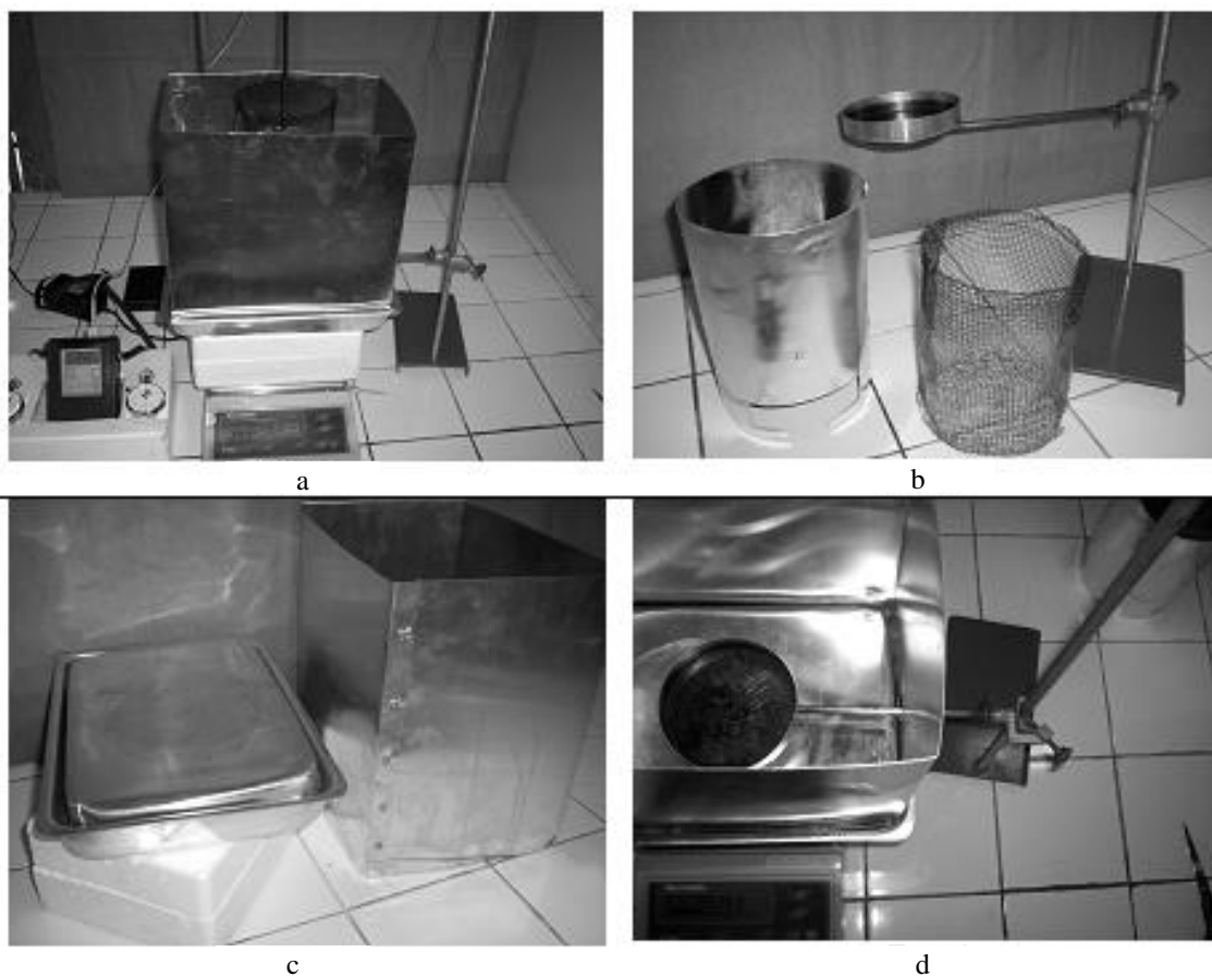
Figura 2. Aparato para os ensaios de combustão das amostras: a– aparato completo com termopar e balança, b– combustor, gaiola e recipiente para álcool, c– anteparo e bandeja com manta isolante e d– recipiente para álcool montado dentro do anteparo (QUIRINO, 1991, com adaptação).
