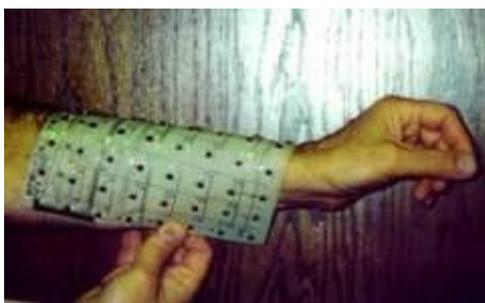
*Fig. 30 Pele artificial robótica
