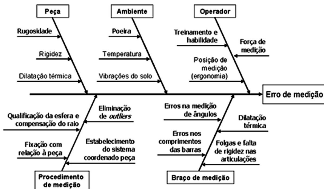
Figura 2.14- Diagrama das fontes de erros num braço articulado (Hamburg-Piekar, 2006)
