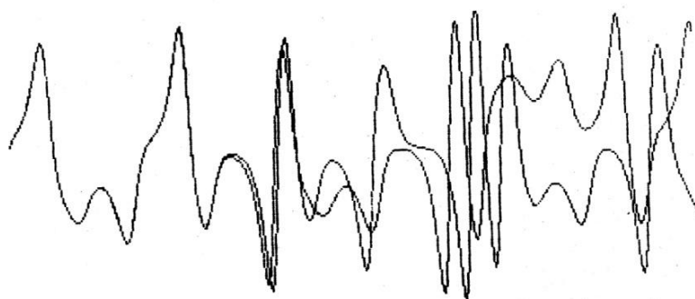
Figura 10 - Ilustração do efeito borboleta. O efeito borboleta: simulação numérica de uma variável no sistema de Lorenz. As curvas representam condições iniciais que diferem em apenas 0,0001. De início elas parecem coincidir, mas logo a dinâmica caótica leva a trajetórias independentes, muito divergentes. Fonte: Stewart (1991, p. 155).
