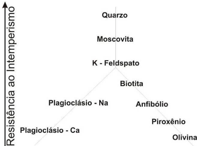
Figura 2.10 - Série de Goldschmidt mostrando a ordem de resistência dos principais silicatos formadores de rochas em relação ao intemperismo.
