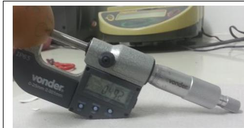
**Figura 3.4** Micrômetro digital
