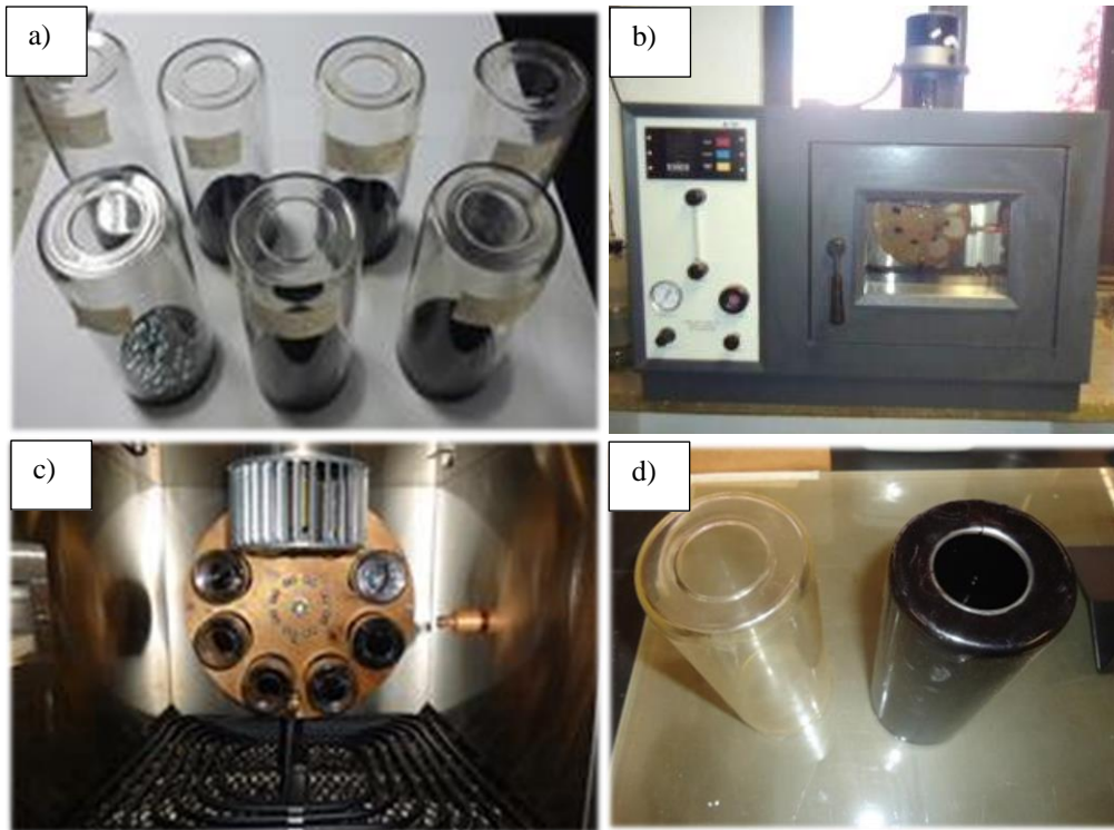
Figura 3.35 Amostras e procedimentos realizados no ensaio de envelhecimento: a) Frascos com amostras antes do envelhecimento; b) Estufa RTFOT; c) Amostras na prateleira da estufa; d) amostra após o ensaio.
