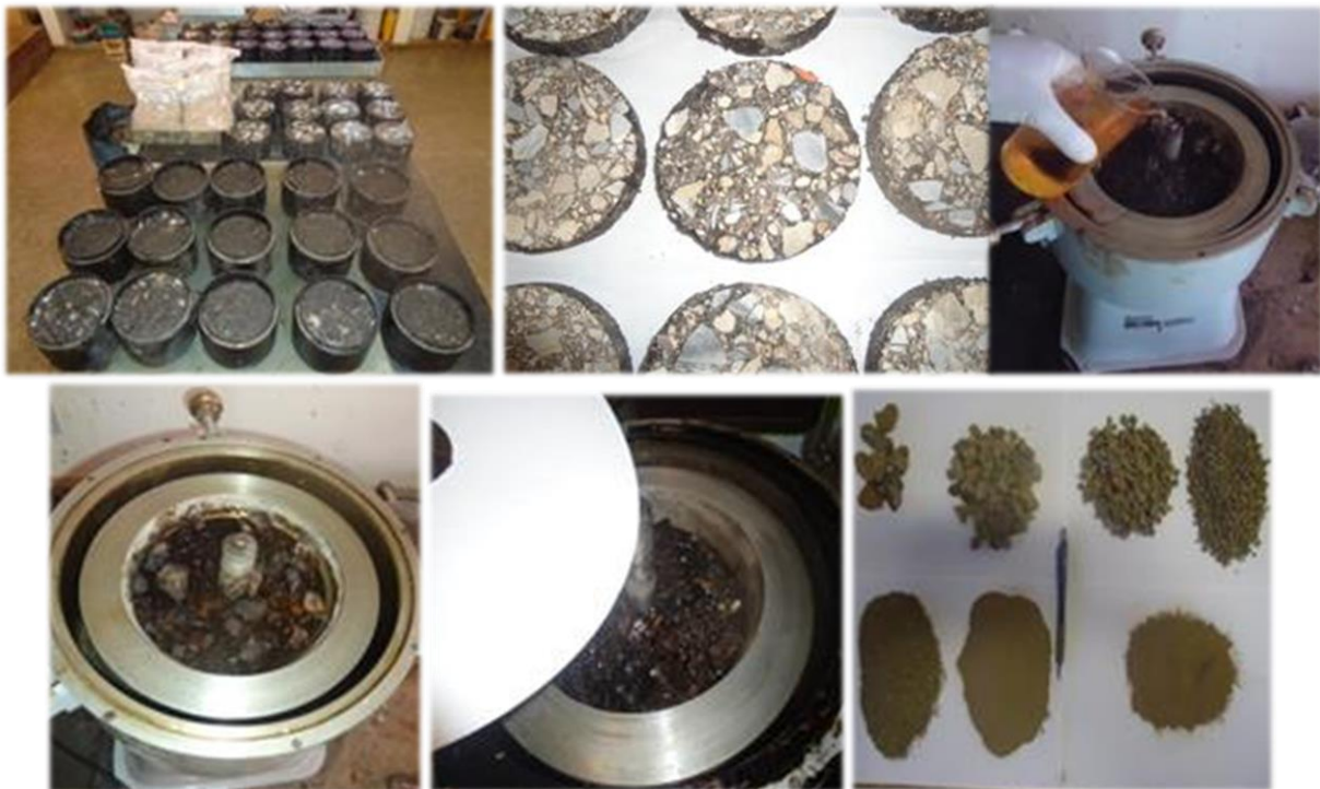
Figura 3.39 Corpos de prova das misturas estudadas e processo do ensaio de extração de ligante asfáltico para fazer a determinação da quebra.
