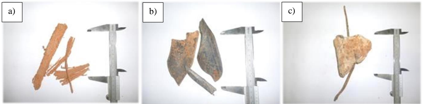
Figura 3.5 Materiais contaminantes no RCD: a) madeira, b) plásticos, c) ferro.
