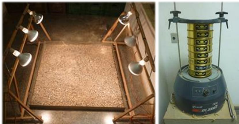
Figura 3.8 Processo de secagem e peneiramento dos RCD.
