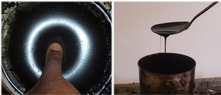
Figura 3.19 CAP: a) Estado viscoelástico na temperatura ambiente; (b) Estado líquido à alta temperatura.
