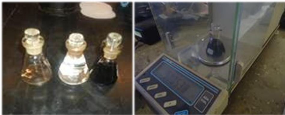
Figura 3.28 Ensaio de determinação densidade de material betuminoso em andamento
