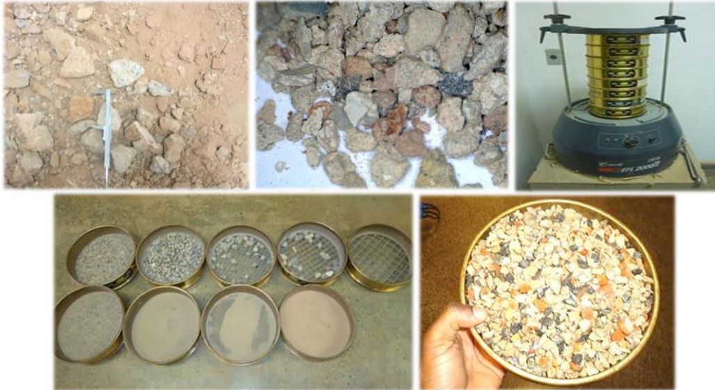
Figura 3.10 Processo de peneiramento dos RCD.
