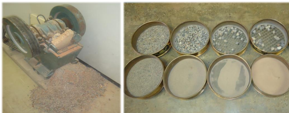
Figura 3.6 Processo de britagem secundário.
