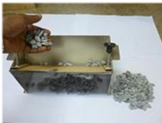
Figura 3.15 Agregado sendo passado pelas lâminas do crivo redutor.
