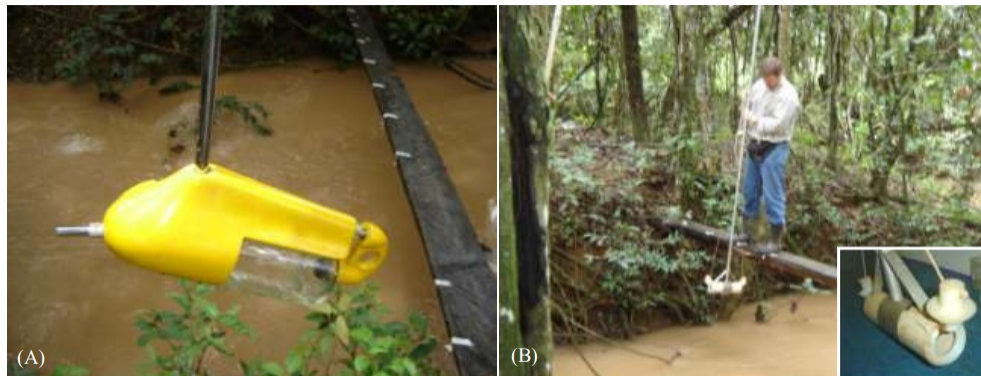
Figura 11- Amostrador por integração na vertical USDH-48 (A) e o amostrador pontual desenvolvido na Embrapa Cerrados e utilizado neste trabalho(B). Fonte: Lima et al. (2010).
