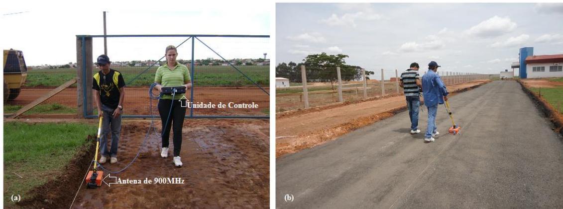
Figura 4.13 – Fotos ilustram a aquisição de dados de GPR, com o sistema SIR 3000 acoplado a uma antena blindada de 900 MHz.
