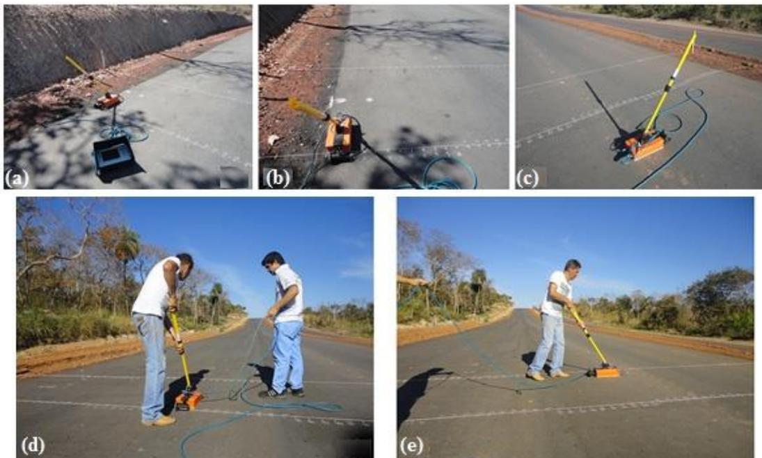
Figura 4.36 - Aquisição de dados com equipamento SIR3000/GSSI, com antena blindada de 900 MHz (a) Equipamento: módulo de controle e antena (b) Antena posicionada para adquirir dados no sentido longitudinal da pista (c) Antena posicionada para adquirir dados no sentido transversal da pista (d) Aquisição de dados no sentido longitudinal da pista (e) Aquisição de dados no sentido transversal da pista.
