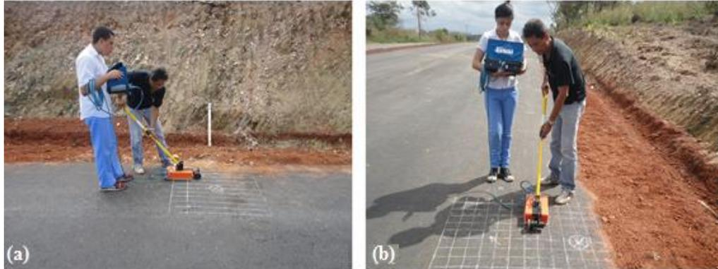
Figura 4.35 – Aquisição de dados com equipamento SIR3000/GSSI, com antena blindada de 900MHz – (a) perfis curtos e paralelos no sentido longitudinal à pista (b) perfis curtos em malha nos sentidos longitudinal e transversal da pista.
