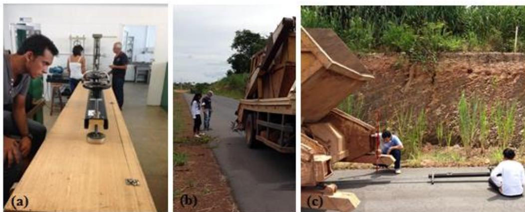
Figura 4.28 – (a) Detalhe do momento da aferição da viga Benkelman; (b) Ensaio com a viga na margem esquerda da pista e; (c) ensaio na margem direita da pista da Avenida Antártica.
