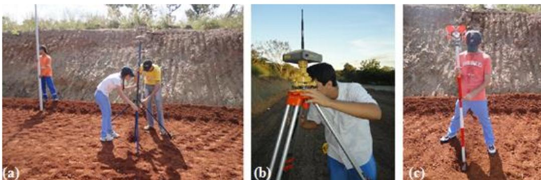
Figura 4.33 – Instrumentos e equipamentos usados pela topografia para registra a localização das placas instaladas nas interfaces das camadas da estrutura da pista – (a) GPS (b) Estação Total e (c) Prisma.
