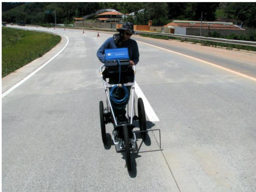
Figura 4.42 – Aquisição de dados na pista de rolamento da BR-101/NE com o equipamento SIR 3000, conectado a antena blindada de 900 MHz.
