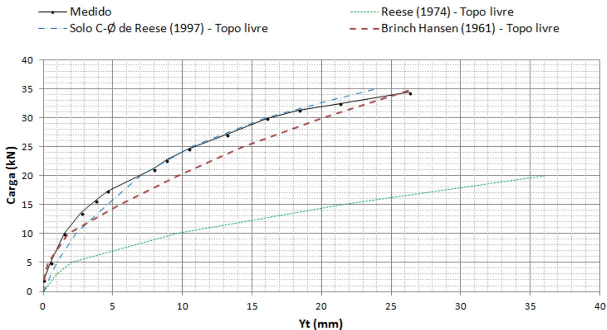
**Figura 4. 19** - Curva carga vs deflexão do topo da estaca isolada, calculada com  $E_p I_p$  variável, em que a seção fissurada é modelada pela relação momento-curvatura bi-linear.
