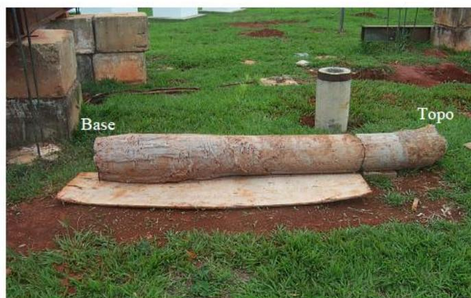
Figura 3. 7 – Estaca hélice contínua exumada (Santos, 2010)
