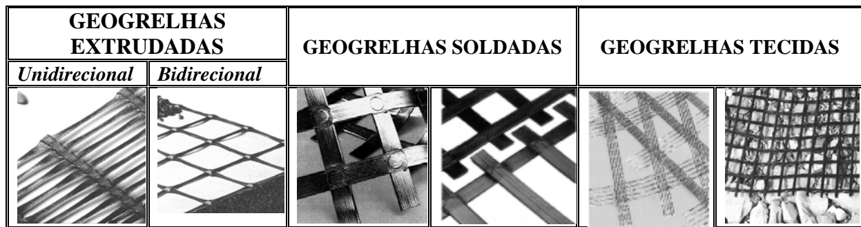
Figura 2.18 Tipos de geogrelhas, (modificado - Sieira, 2003)
