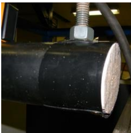
Figura 3.29 Detalhe extensão de borracha e tampa de isopor no tubo.
