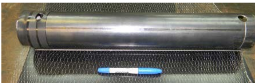
Figura 3.27 Preparação de um corpo de prova RP na configuração 3 com ajuda da lamina de aço no fundo para assegurar o reforço.
