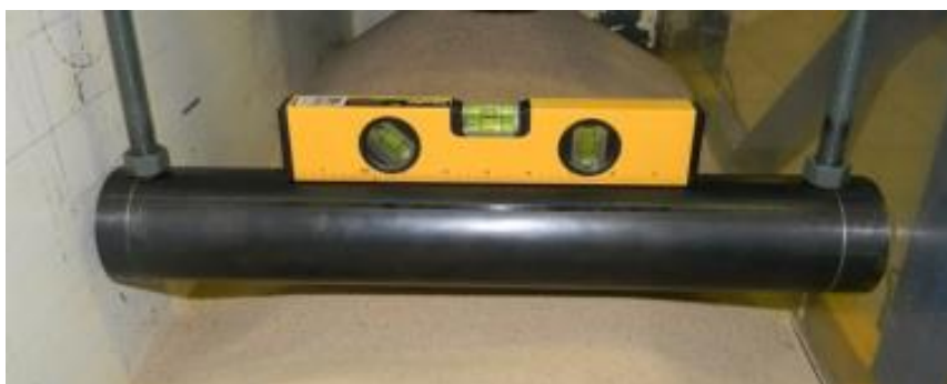
Figura 3.28 Tubo de aço carbono - Instalação do duto no fundo da caixa de testes.
