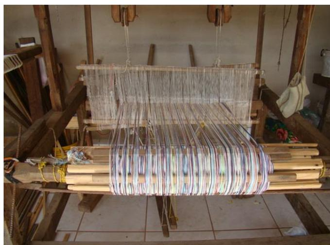
Figura 31 – Urdume montado em um tear que foi produzido pelo Silvio Machado com madeiras encontradas na região (foto do autor).
