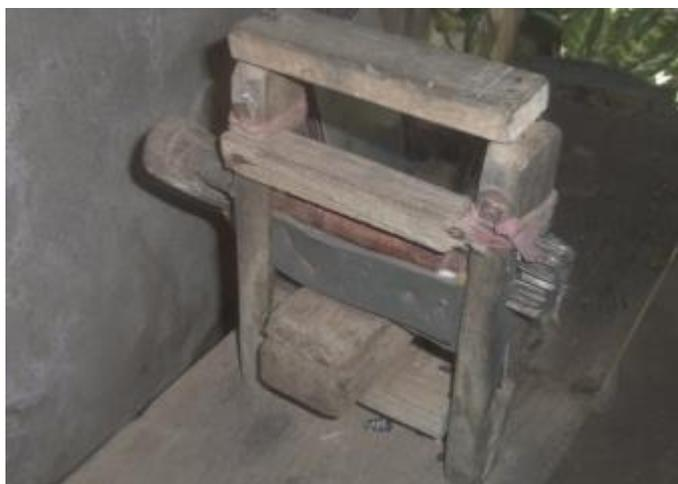
Figura 27 – Este descaroçador apresentado é similar aos encontrados em livros e é ainda hoje utilizado pela Trama para limpeza do algodão (foto do autor).
