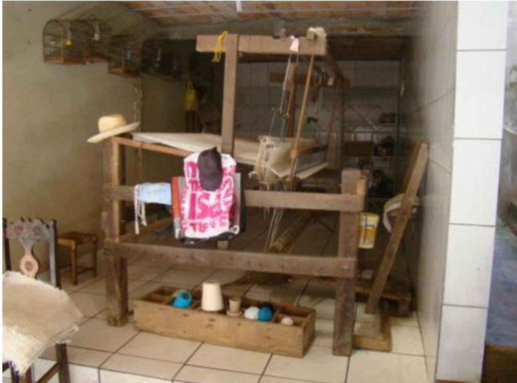
Figura 26 – Tear de mesa com quatro pedais de fabricação artesanal, produzido pelo patriarca da família Alvarenga, este tar foi trazido da fazenda em que a família morava e foi produzido com madeira de demolição ou encontrada nas matas (foto do autor).
