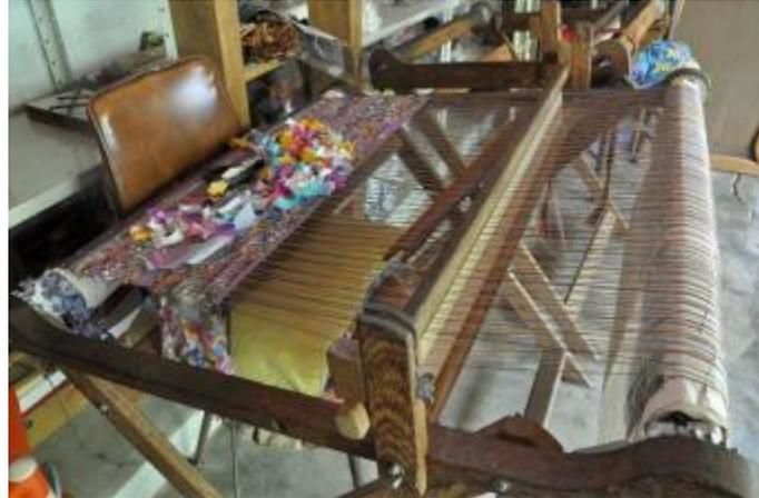
Figura 44 – Tear de pente liço, inovação estrutural implementada no Tissume em relação aos pesados teares tradicionais (foto de Rafael Dietzsch).
