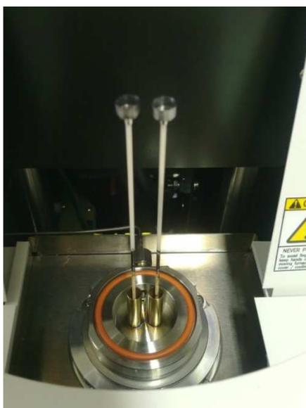
**Figura 17.** Câmara de combustão e celas de analisador termogravimétrico DTG - 60 Shimadzu.
