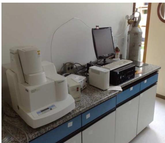
**Figura 16.** Vista parcial do Laboratório de Materiais Combustíveis, com destaque para o analisador termogravimétrico DTG - 60 Shimadzu.
