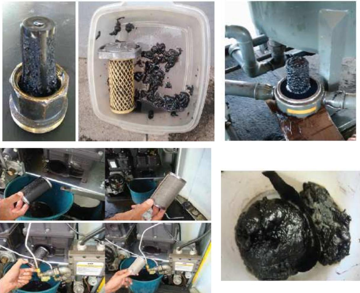
**Figura 4.** Imagens de formação de borras em bombas de abastecimento de combustível em condições reais de operação.<sup>3-4</sup>
