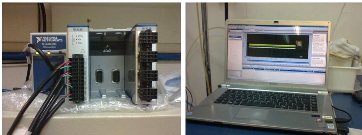
Figura 3.10 - a) Módulo de aquisição NI cDAQ 9174 da NI e b) sistema de tratamento de dados.
