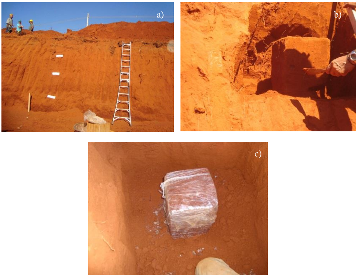
Figura 3.2 - a) Talude de retirada da amostra, b) Confecção do bloco de amostra e c) Bloco acondicionado para transporte.
