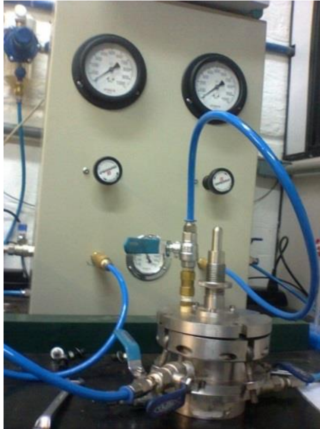
Figura 2.24 - Câmara de sucção e painel de controle das pressões.
