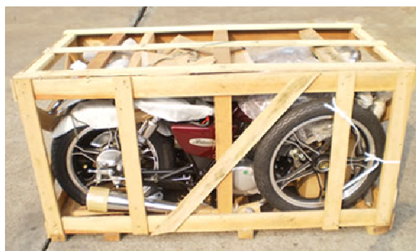
FIGURA 31 – Racks utilizado para embalar motocicletas para o transporte, feitos de metal ou madeira Fonte: motonline.com
