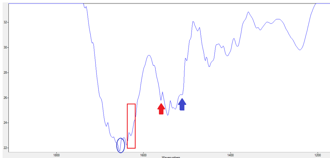
Figura 37. Aproximação do gráfico de FTIR mostrando as bandas vibracionais da tirosina (seta azul), da glutamina (seta vermelha), as bandas vibracionais das folhas-beta (quadrado vermelho) e as bandas vibracionais das alfa-hélices (circulo azul).
