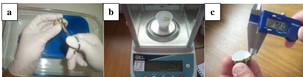
Figura 2.3 a. Corte da casca do ovo com a tesoura. b. Pesagem das cascas secas. c. Detalhe do paquímetro digital MITUTOYO® medindo a espessura da casca.
