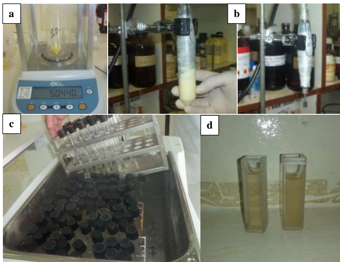
Figura 2.5 a. Pesagem do “pool” de gema de dois ovos para análise de oxidação lipídica. b. Homogeneizando a amostra no Turrax. c. Detalhe das amostras no banho-maria. d. Amostras nas cubetas para determinação do TBARS em espectrofotômetro.
