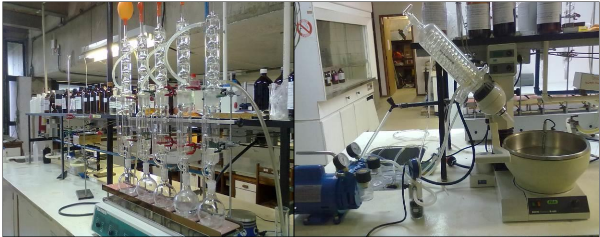
Figura G.1 - Aparelho de extração de óleos e graxas utilizado na pesquisa.
