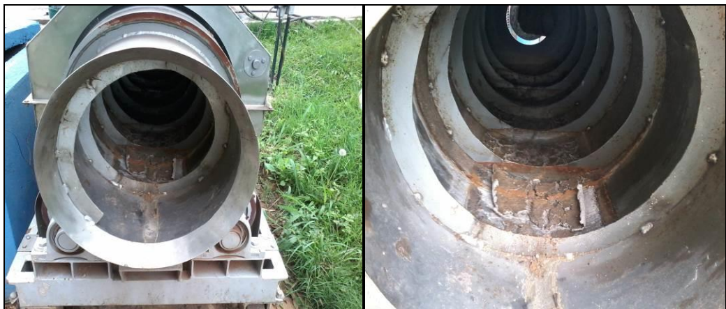
Figura 5.7 - Peneira rotativa após o uso com resíduos gordurosos.
