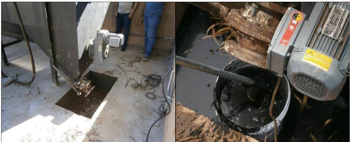
Figura G.4 - a) Saída do adensado da unidade central de pré-tratamento (à esquerda); b) coleta de amostras ao final de uma campanha de monitoramento recebendo somente lodos de fossas (à direita).
