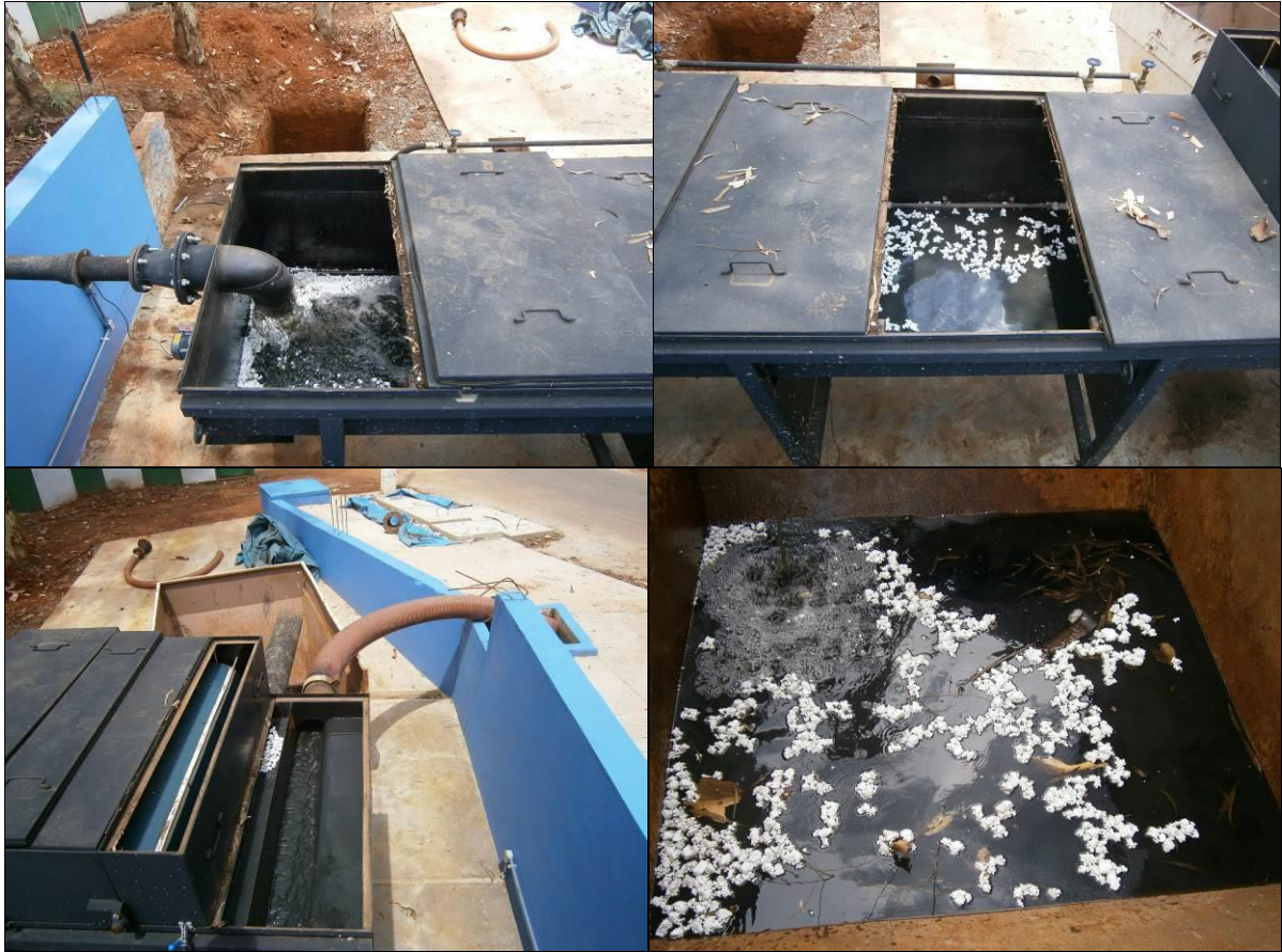
Figura G.5 - Registro fotográfico do comportamento da unidade central com testes realizados com isopor. a, b e c) unidade central; d) presença do isopor no container após o utilizar o raspador superficial
