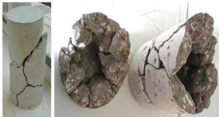
Figura 2.8 – Representação da fissuração e fragmentação nos planos axiais e radiais do corpo de prova (Morais et al., 2010)
