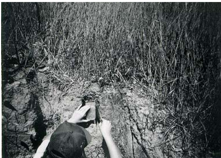
Figura 2. Segunda etapa de coleta de micromonólito.
