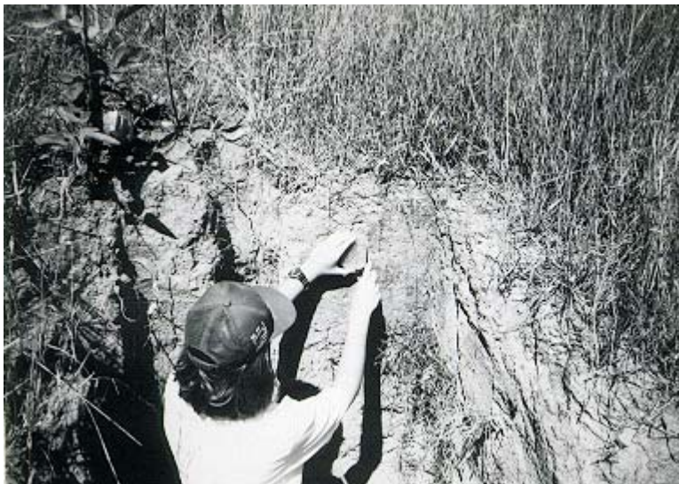
Figura 1. Primeira etapa de coleta de micromonólito.
