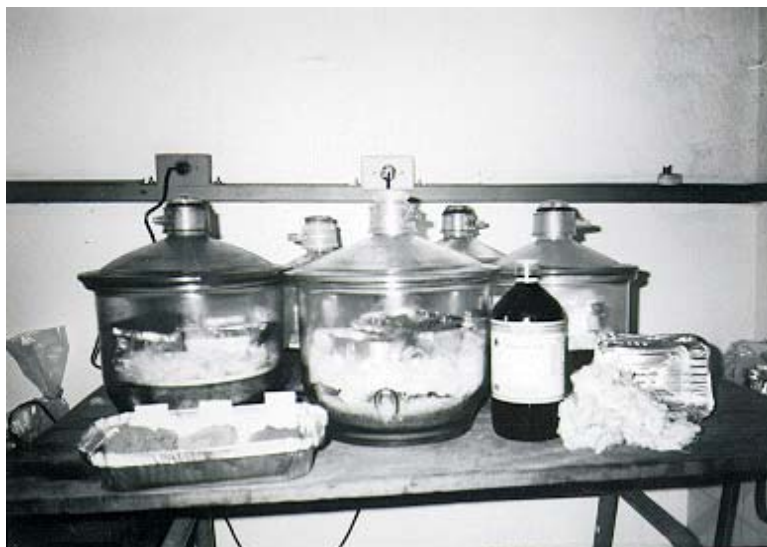
Figura 5. Procedimento de impregnação utilizando dessecador.
