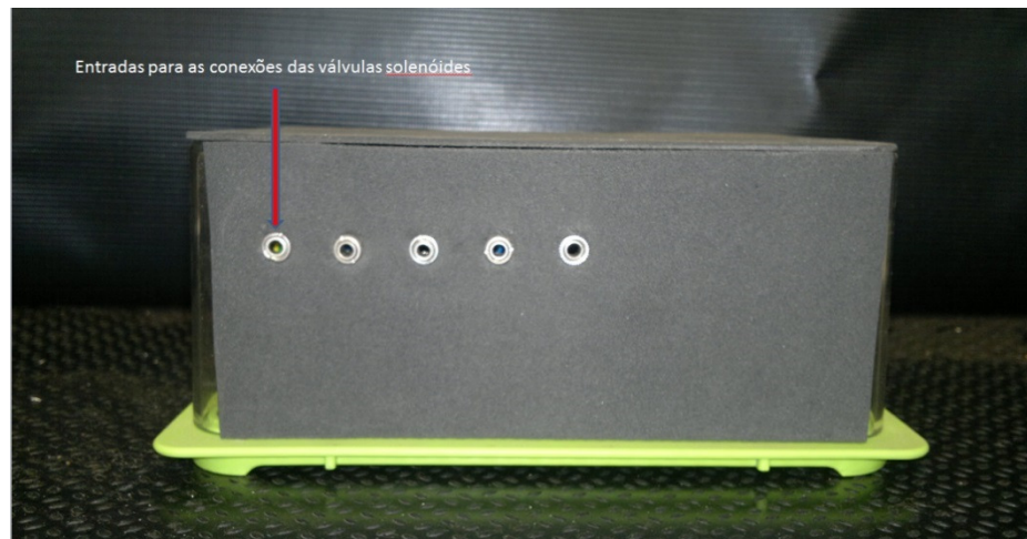
Figura 23. Fotografia da parte frontal da caixa plástica para acondicionamento do circuito microcontrolador.
