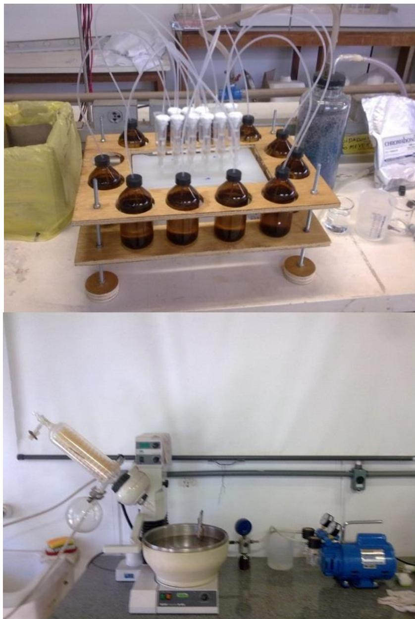
Figura 4.7 - Bloco de extração (acima) e sistema rotaevaporador (abaixo).
