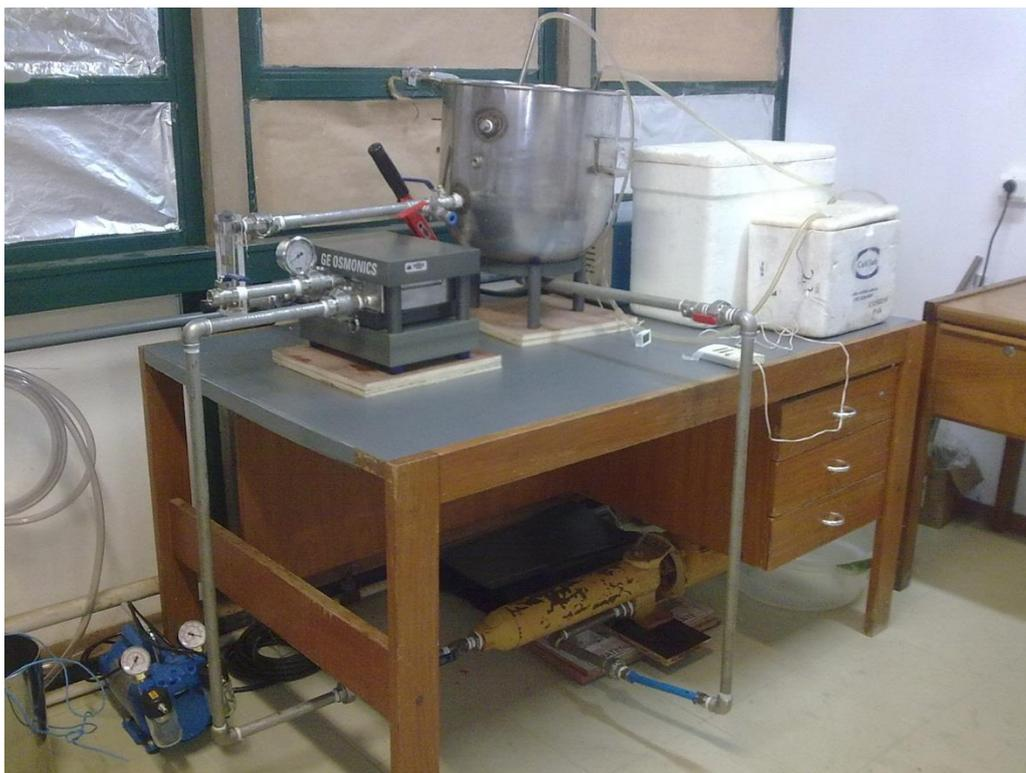
Figura 4.2 – Visão geral do sistema de nanofiltração.
