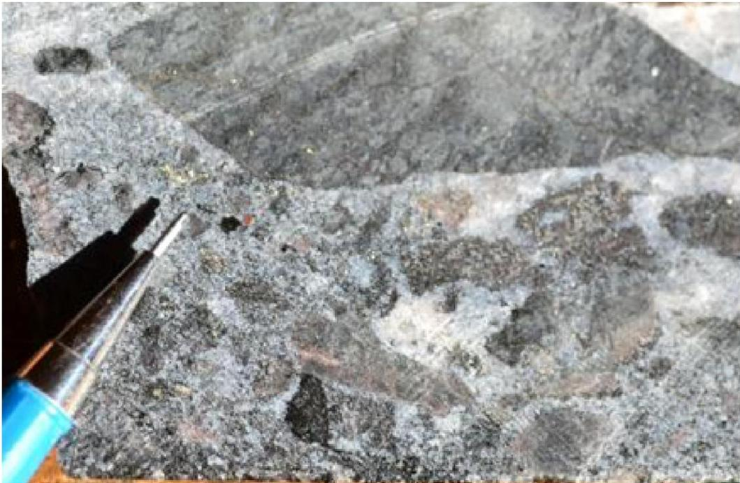
**Figura 4.3:** Brecha cálcio-silicática. Notar a matriz composta principalmente por quartzo e carbonato além de finos cristais aciculares de turmalina.
