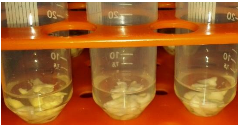
Figura 8 – Mucosas contaminadas com FLU imersas em 5,0 mL de uma mistura de água Milli-Q:metanol (1:1, v/v) para avaliação da recuperação do fármaco.
