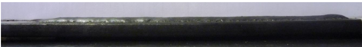
Figura 5.24: Cordão final obtido depois do controle para uma altura do reforço de 2.5 mm com arame tipo maciço.
