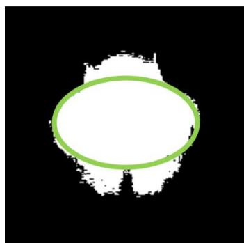
Figura 4. 21: Elipse que representa a poça de fusão.
