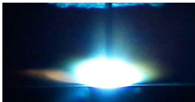
Figura 4. 11: Imagem adquirida com forte influência da luz do arco.
