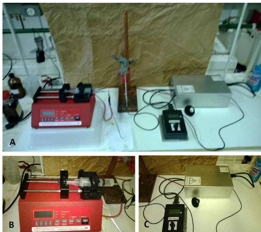
Figura 7: Sistema de electrospinning completo (A), bomba infusora usada para controlar o fluxo de vazão da solução (B) e fonte de alta tensão (C).
