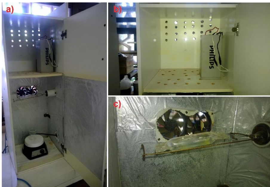
Figura 8: Imagens do fotorreator onde se vê a) a montagem geral, b) reator para lâmpada de 400 W de uso externo (para postes de iluminação pública) e c) a lâmpada de vapor de mercúrio de 400 W usada em iluminação pública na qual o bulbo contendo o filtro de radiação UV foi retirado
