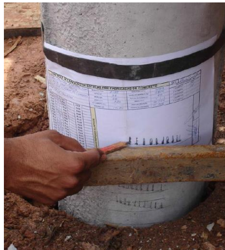
Figura 2.16 Coleta do repique elástico durante a PCD – (In Situ Geotecnia S/C)
