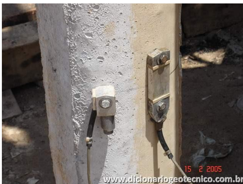
Figura 2.18 Sensores instalados na estaca para a realização do PCD
