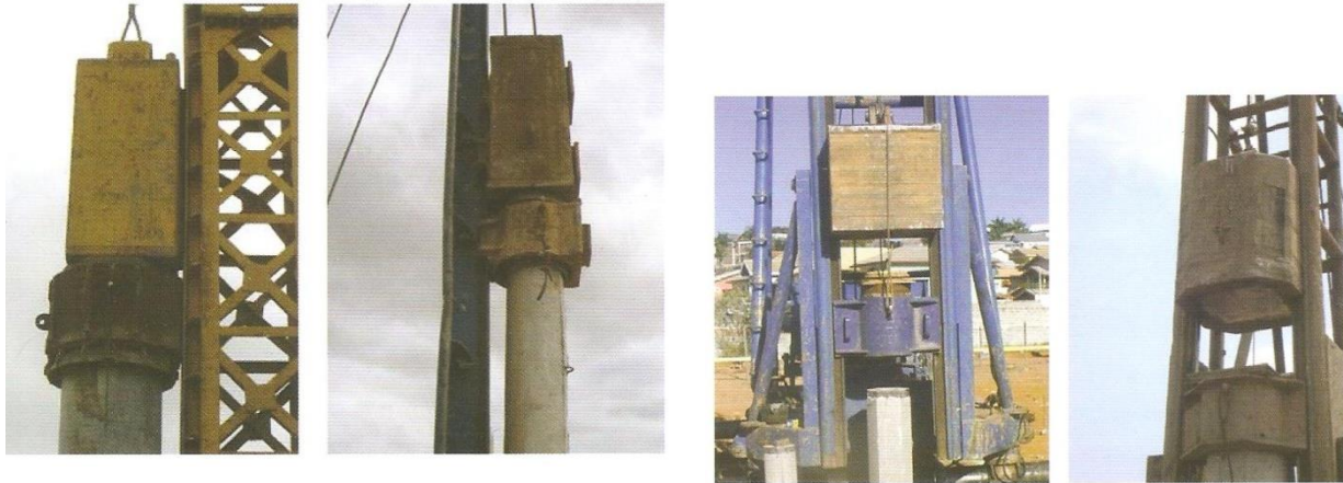
Figura 2.3 Sistemas de acoplamento interno e externo de martelos de queda livre às torres (Gonçalves et al. 2007)
