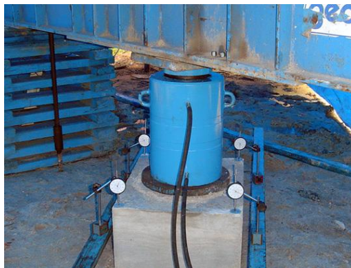
Figura 2.22 Esquema de montagem de uma Prova de Carga Estática ( http://www.engenhariacivil.com/imagens/controlo-qualidade-estacas.jpg )
