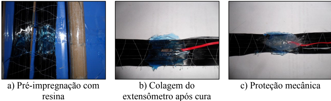
Figura 3.15 – Instrumentação antes da aplicação do reforço na série 2
