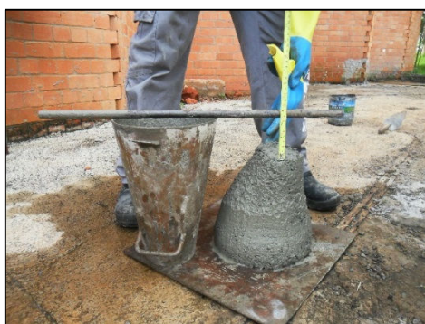
a)Ensaio abatimento de tronco de cone
