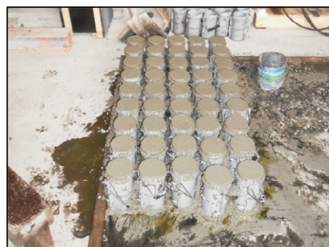
b)Moldagem corpos de prova
