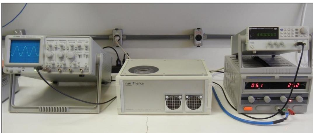
**Figura 18.** Equipamento gerador de campo magnético de frequência alternada (MagneTherm, NanoTherics). À esquerda, osciloscópio; ao centro, a bobina geradora do campo magnético; e à direita, a fonte de tensão.
