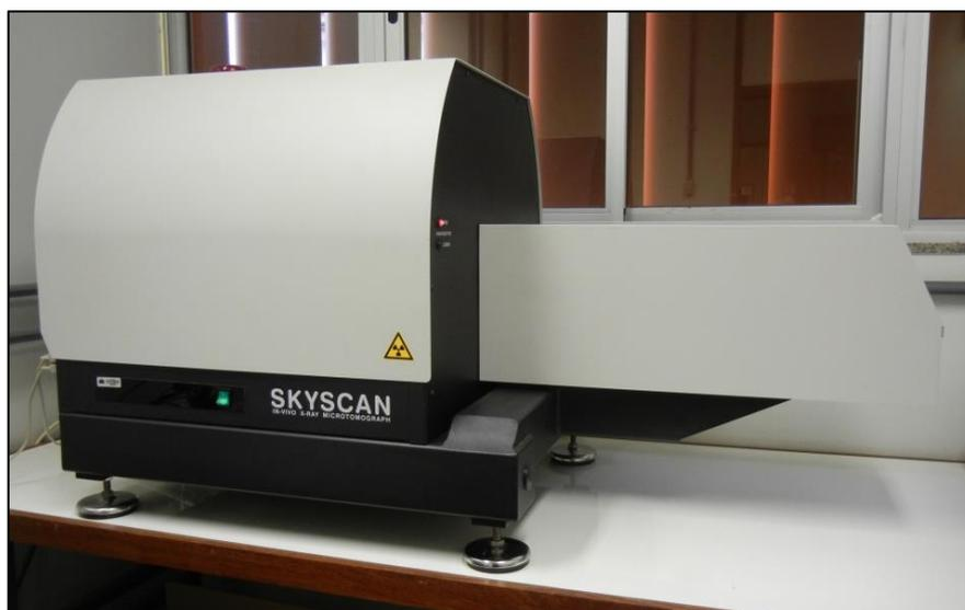
**Figura 19.** Equipamento de microtomografia computadorizada, modelo 1076 (SkyScan).
