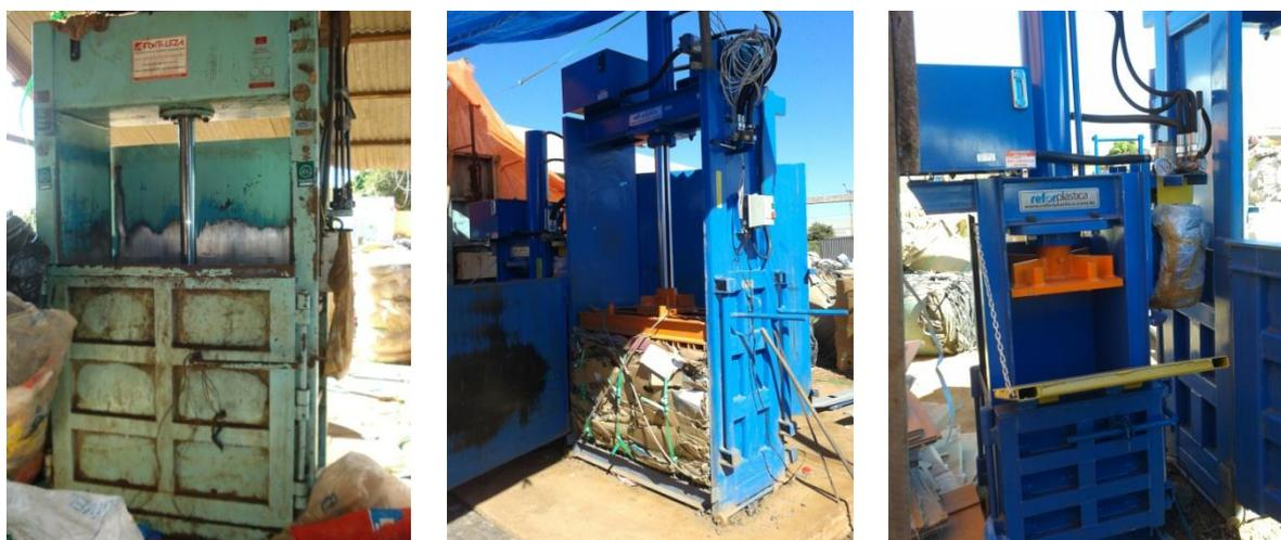
**Figura 4. Prensa fechada, prensa aberta com material dentro já enfardado, e prensa para latinhas de metal**
