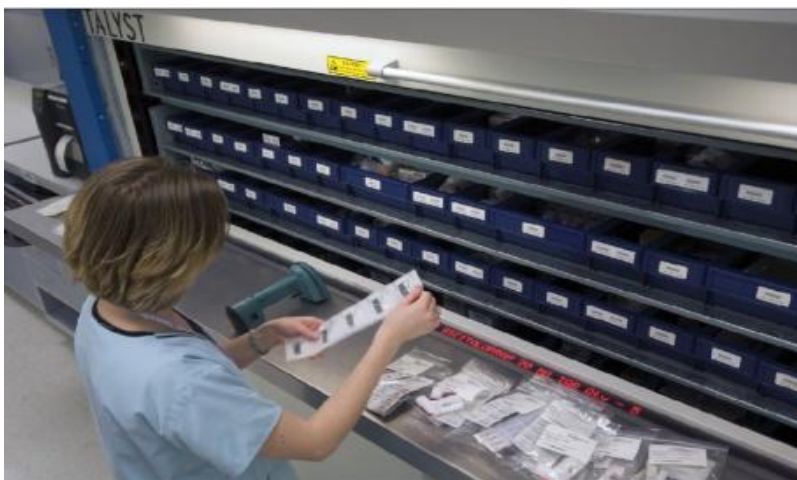
Figura 3: Sistema de dispensação com armários rotativos chamado carrossel. Fonte: (BONVINO; OCTOCKI, 2010).
