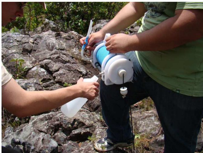
Figura 8. Coleta de amostras de água utilizando a garrafa de Van Dorn .
