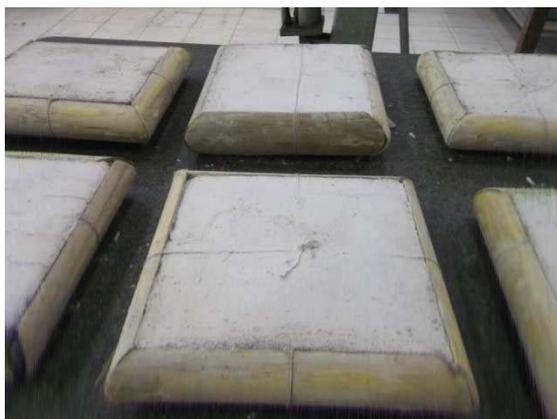
Figura 3.44: Aspecto visual dos painéis de bambu após a secagem da argamassa.
