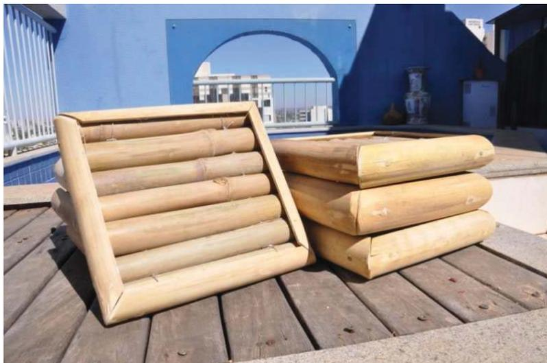
Figura 3.31: Estruturas de bambu finalizadas, antes de serem submetidas ao tratamento imunizante da mineralização.
