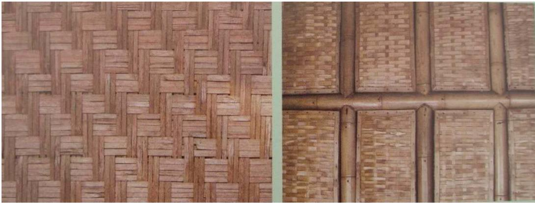
Figuras 1.25 (a e b): Painel feito com peças trançadas de bambu.
