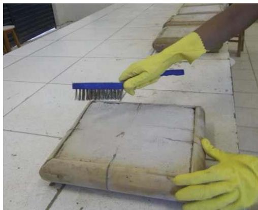
Figura 4.45: Aplicação da lixa de tiras de chapa de aço, nas superfícies argamassadas dos painéis de bambu.
