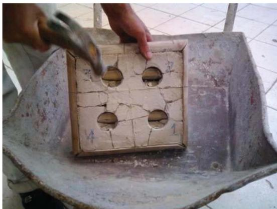
Figura 4.16: Momento da remoção da argamassa de revestimento para retirada dos bambus do interior do painel.
