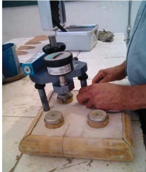
Figura 4.58: Ensaio de aderência à tração da argamassa em painel envelhecido de forma acelerada.
