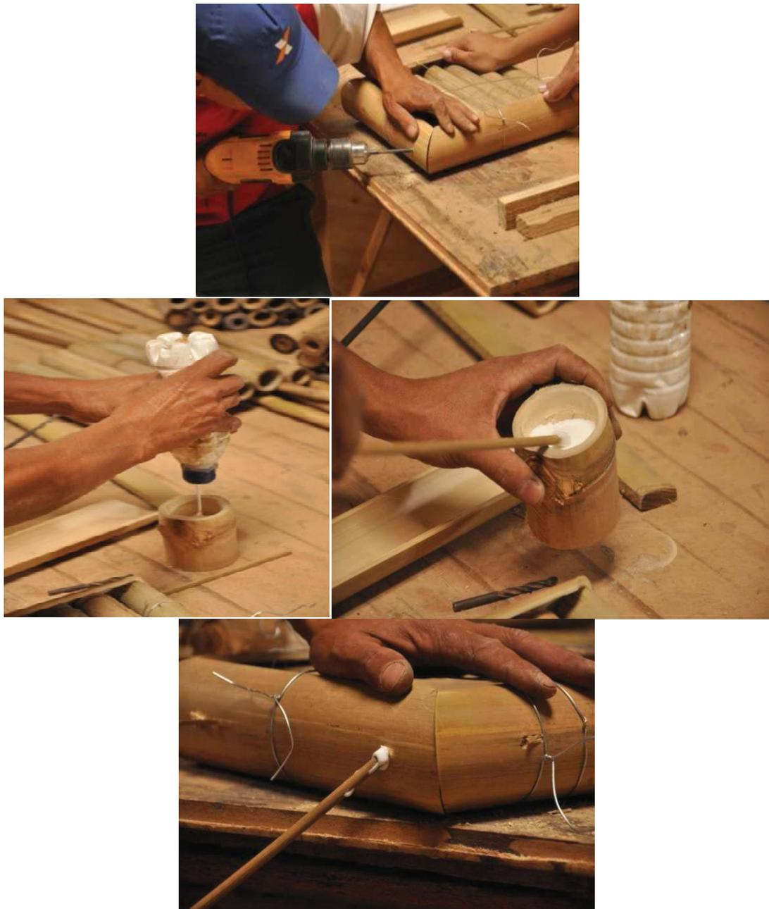
Figura 3.30: Processo de “pinagem” das molduras do painel de bambu.
