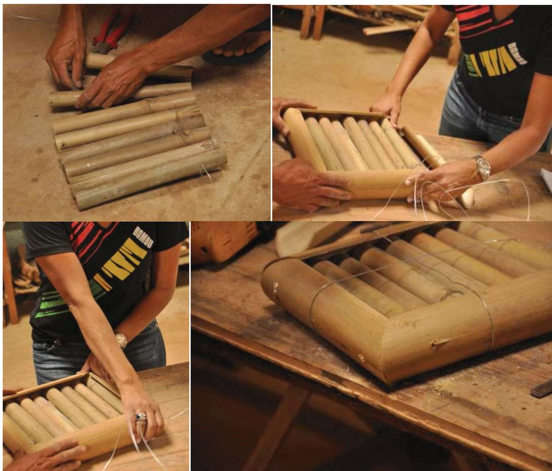
Figura 3.29: Processo de montagem do painel de bambu.
