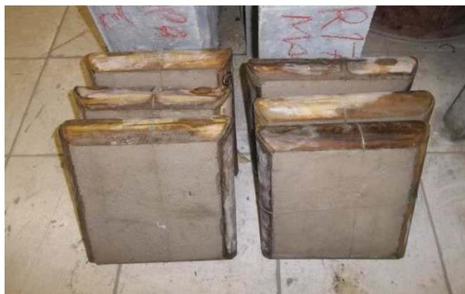
Figura 4.43: Painéis descansando na posição vertical para escoamento do excesso de água.
