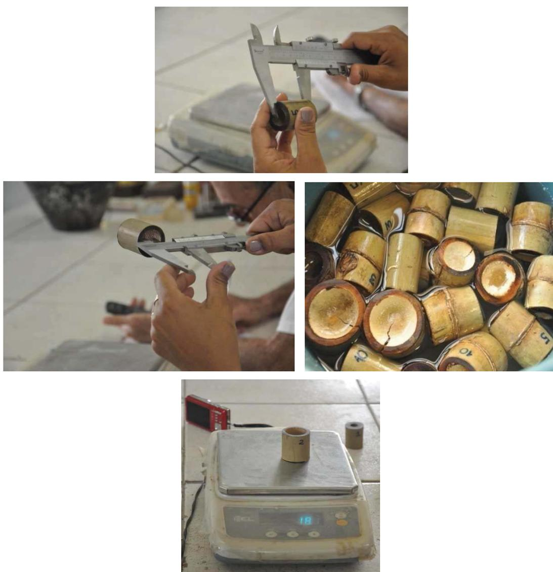
Figura 4.6: Imagens do processo de medida da densidade saturada dos bambus *in natura*.
