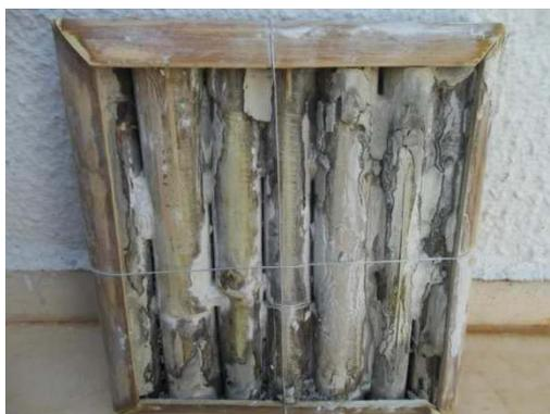
Figura 3.36: Aspecto do painel de bambu após a Mineralização: natas de cimento aderidas à superfície externa do painel.
