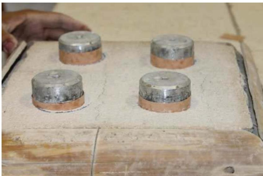
Figura 4.57: Painel de bambu preparado para o ensaio de resistência de aderência à tração da argamassa, com as pastilhas já aderidas à argamassa de revestimento.
