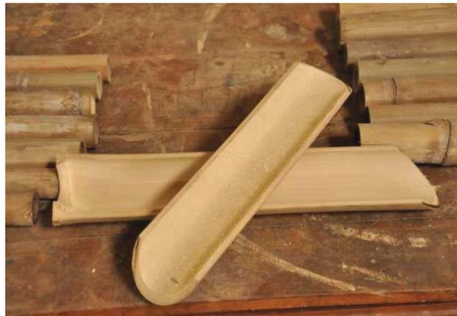
Figura 3.27: Moldura de bambu com as extremidades chanfradas em 45°.
