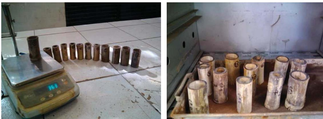
Figura 4.50 (a) e (b) : Corpos de prova feitos a partir das colmos de bambu, envelhecidos naturalmente.
