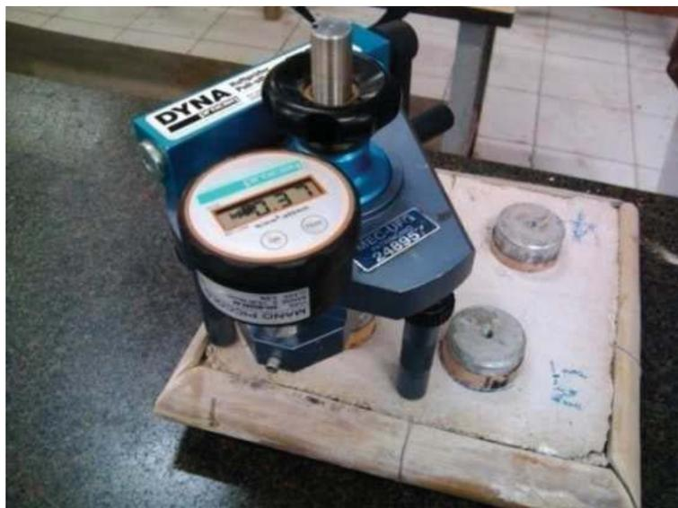
Figura 4.20: Equipamento DYNA PROCEQ, utilizado no ensaio de resistência de aderência da argamassa de revestimento.
