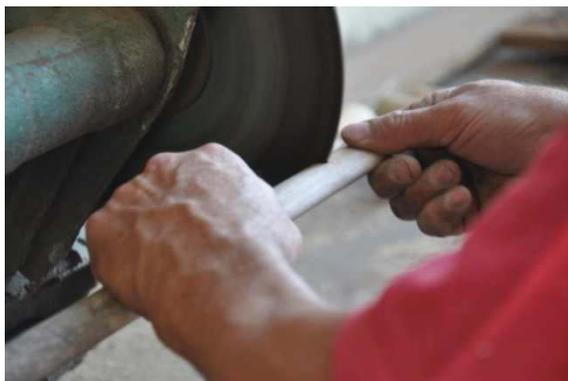
Figura 4.3: Bambus sendo serrados em serra elétrica para a produção de corpos-de-prova.
