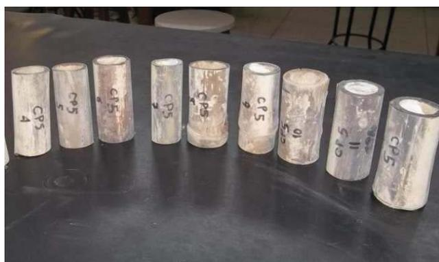
Figura 4.54: Corpos de prova extraídos de um painel envelhecido de forma acelerada, produzido para o ensaio de compressão paralela às fibras.
