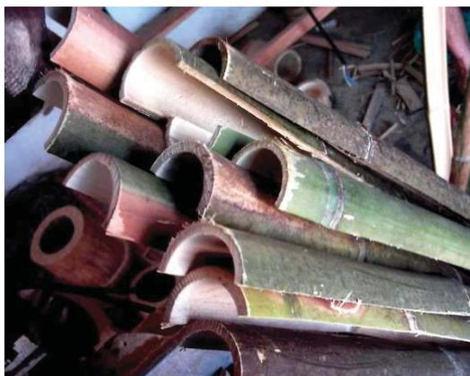
Figura 3.5: Bambu cortado em meia-cana (*Phyllostachys bambusoides*), para confecção das molduras dos painéis.
