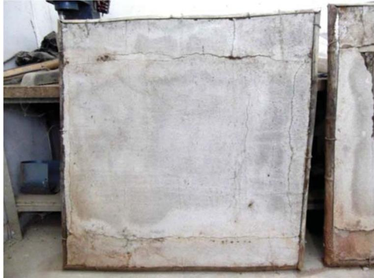
Figura 4.25: Aspecto visual do painel de bambu, após o processo de exposição prolongada aos agentes de degradação natural.
