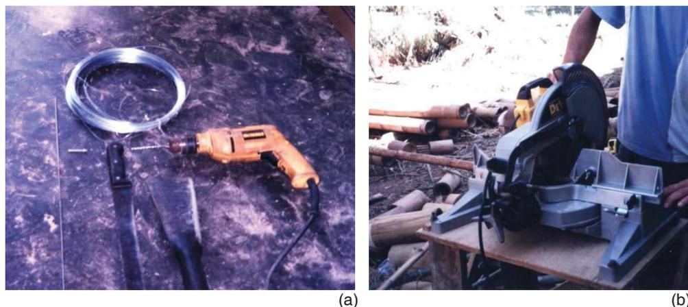
Figura 3.3: Ferramentas simples utilizadas na execução dos painéis (a); Serra circular, equipamento apropriado para o corte dos bambus (b).
