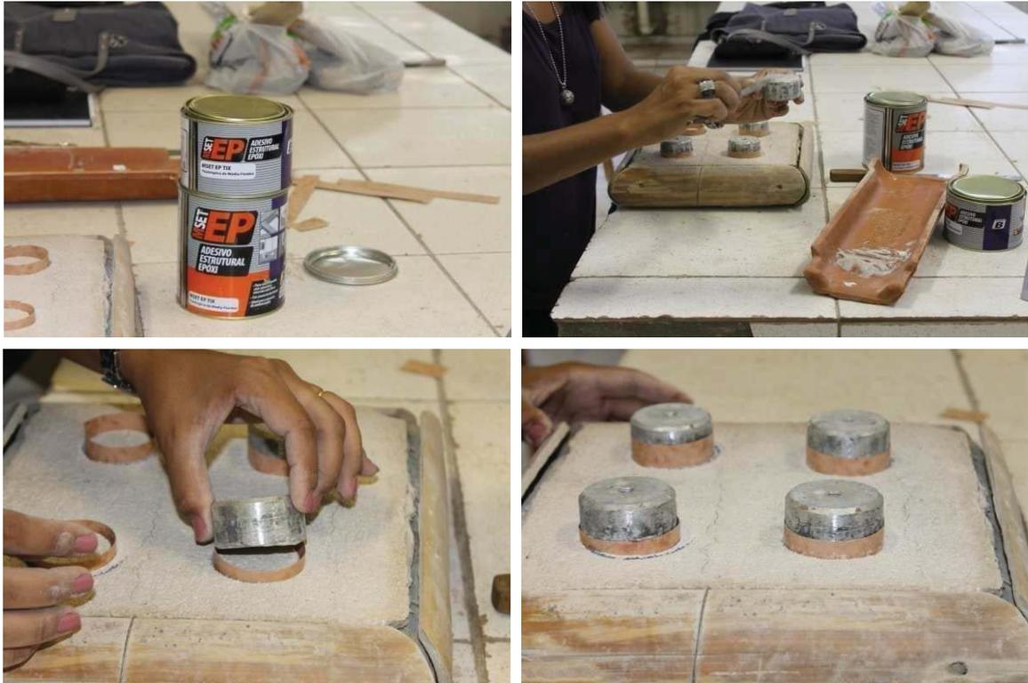
Figura 4.21: Etapa preliminar à realização do ensaio de aderência da argamassa: colagem das pastilhas metálicas nos painéis de bambu.
