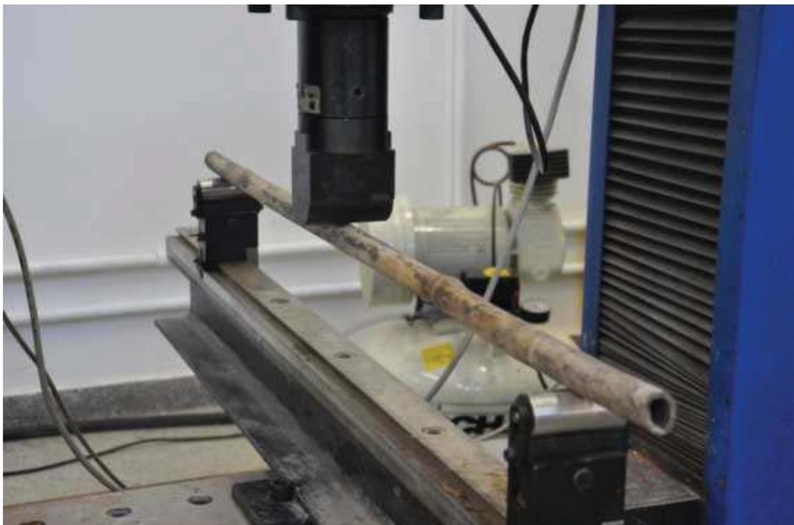
Figura 4.37: Ensaio de flexão dos colmos de bambu envelhecidos naturalmente.
