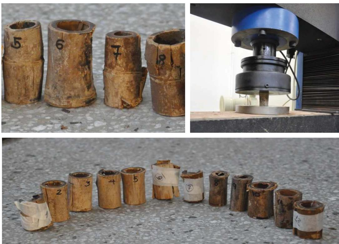
Figura 4.35: Imagens relativas ao ensaio de resistência à compressão paralela às fibras.
