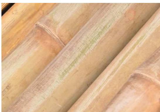
Figura 3.33: A imagem mostra o aspecto do bambu após aplicação da lixa grossa para madeira, com ranhuras na superfície lisa do bambu.
