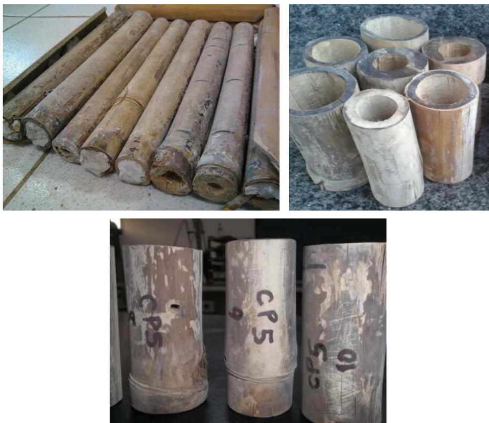
Figura 4.49: Aparência dos bambus mineralizados, que foram retirados dos painéis de bambu submetidos ao processo de envelhecimento acelerado.
