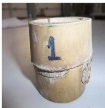
Figura 4.8: Detalhe de um corpo de prova de bambu *in natura*, utilizado para ensaio de compressão paralela às fibras.
