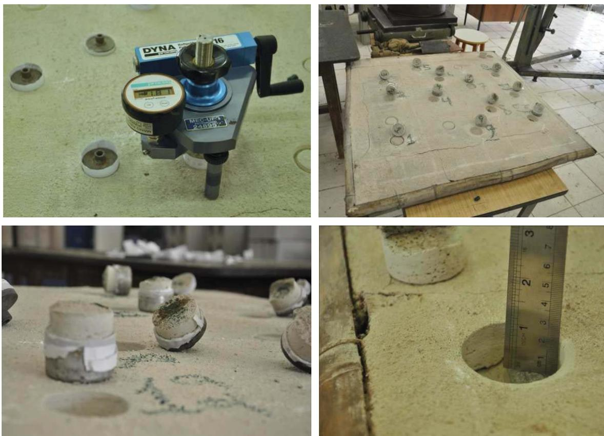
Figura 4.39: Ensaio de aderência à tração da argamassa de revestimento em painel de bambu envelhecido naturalmente.
