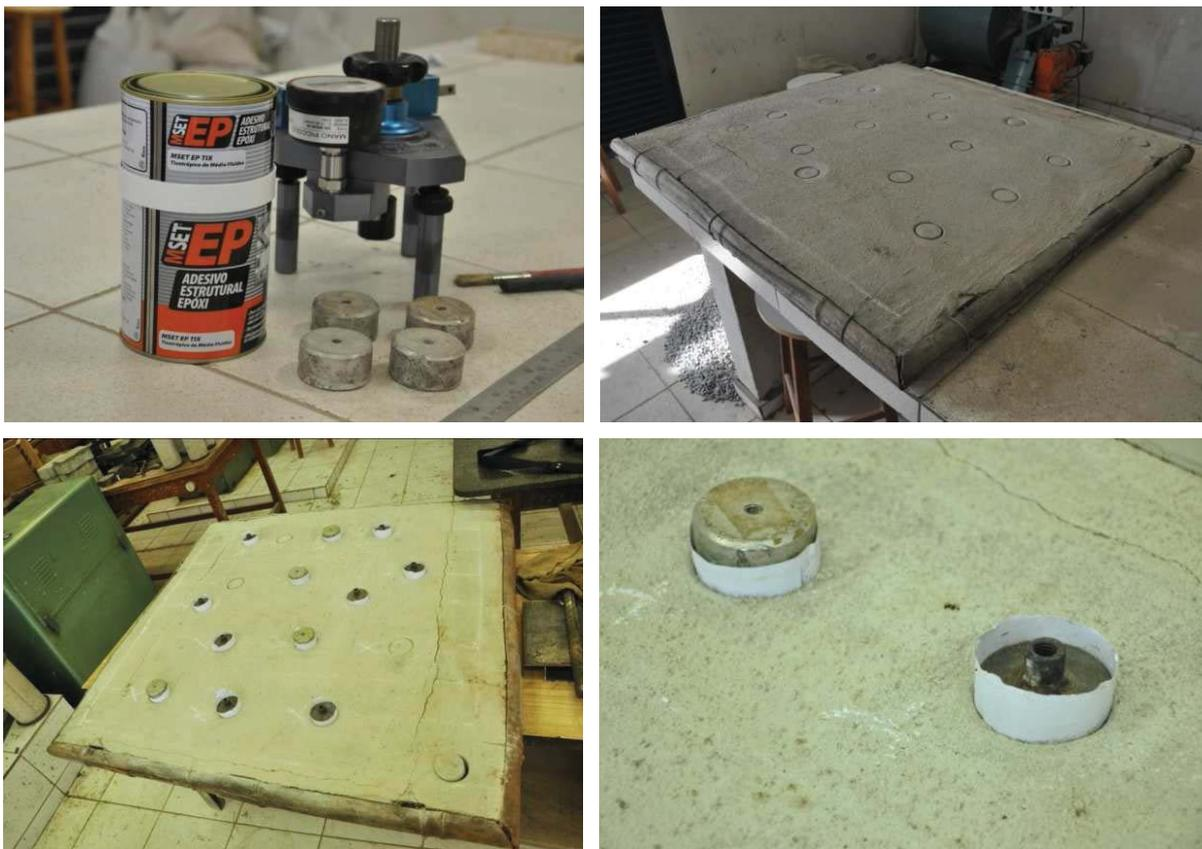
Figura 4.38: Preparação para o ensaio de aderência à tração da argamassa de revestimento do painel de bambu envelhecido naturalmente.
