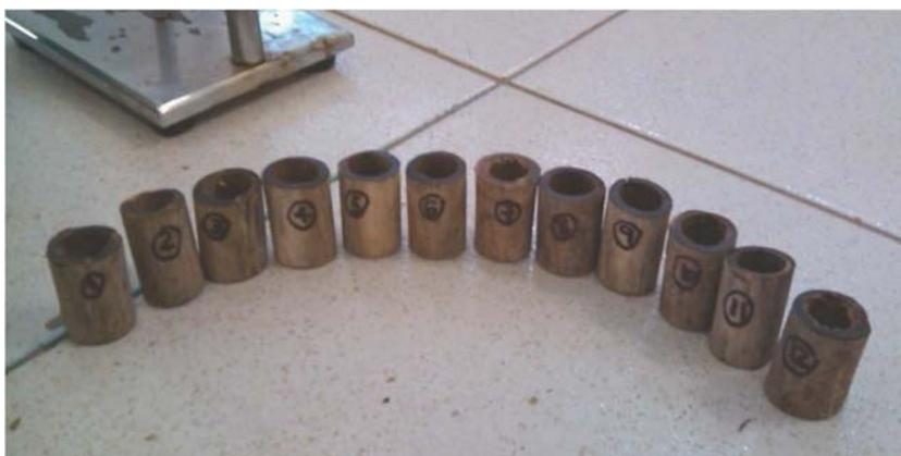
Figura 4.32: Corpos de prova feitos a partir de colmos de bambu envelhecidos naturalmente, sem nós.
