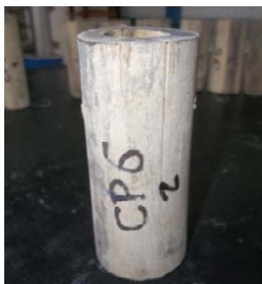
Figura 4.53: Corpo de prova extraído de um painel envelhecido de forma acelerada, produzido para o ensaio de compressão paralela às fibras.
