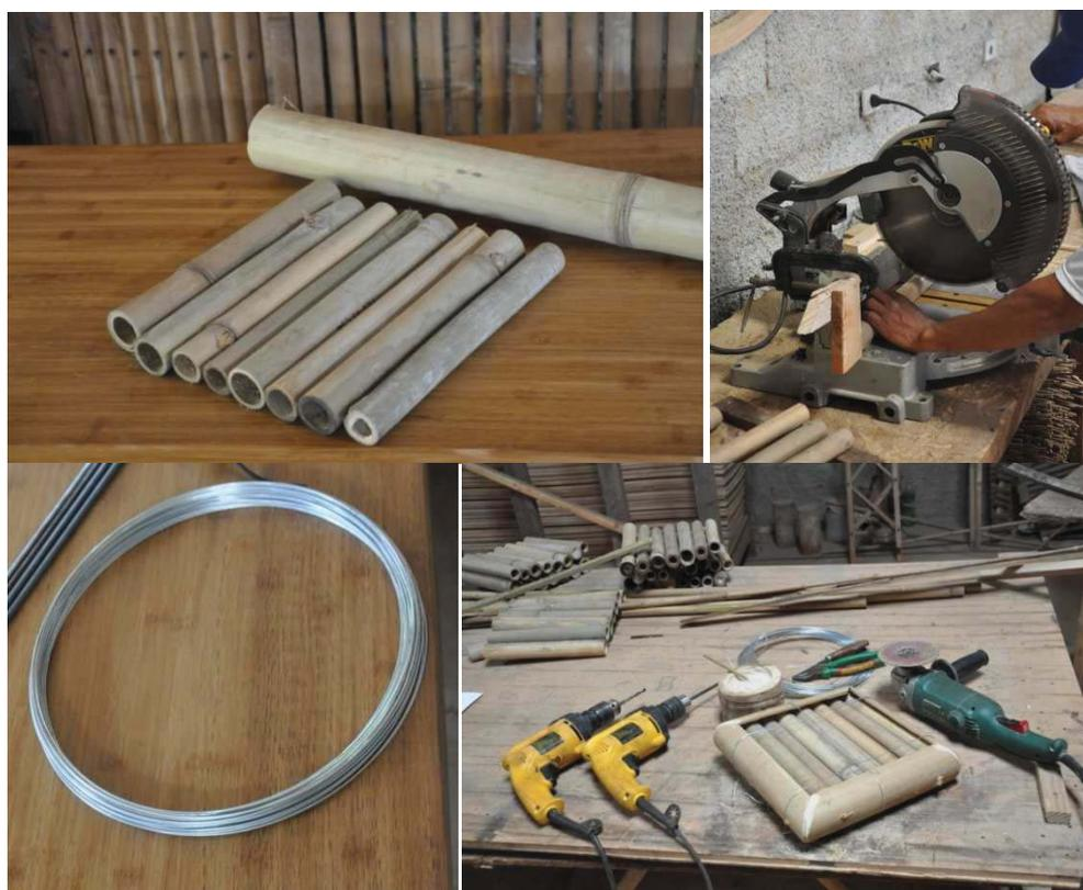
Figura 3.24: Imagem de materiais e equipamentos utilizados na produção dos painéis de bambu para ensaios de envelhecimento acelerado.
