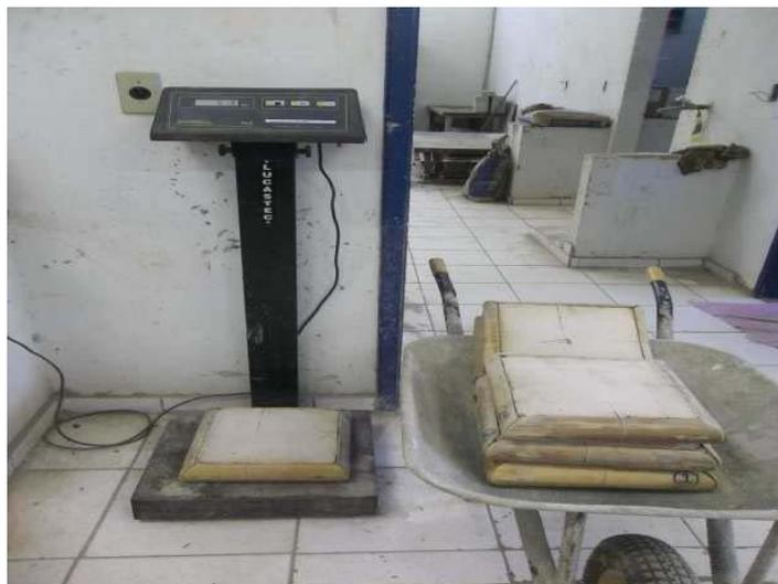
Figura 4.46: Averiguação do peso dos painéis de bambu após a etapa de secagem em estufa.
