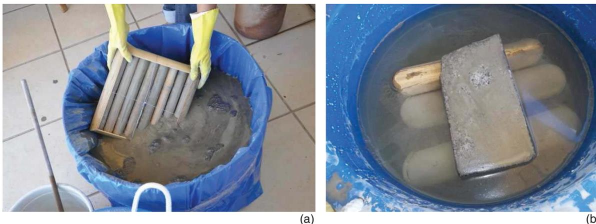
Figura 3.35: Painéis de bambu sendo mergulhados na calda de cimento (a); Colocação de um peso sobre os painéis, para que fiquem totalmente submersos na calda de cimento (b).
