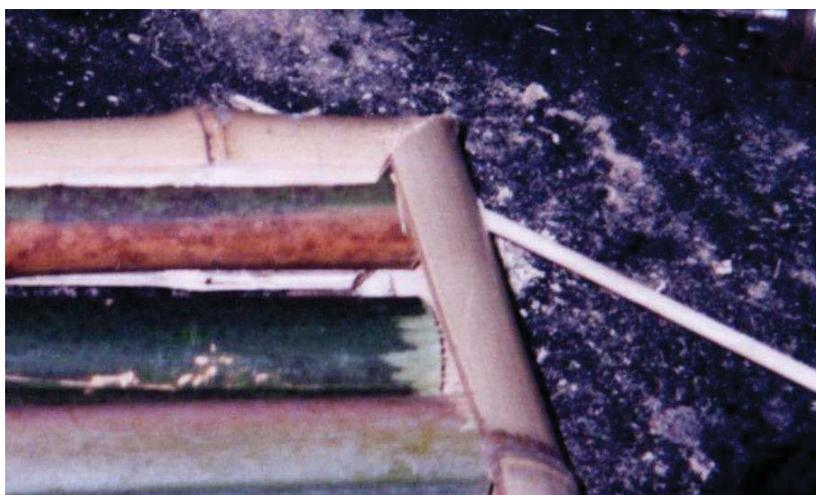
Figura 3.6: Processo de “pinagem” para a união das molduras.
