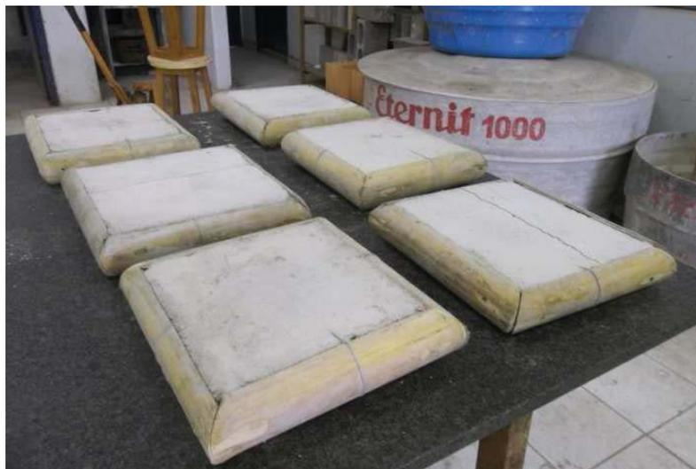
Figura 4.41: Seis corpos de prova de bambu argamassados, preparados para o ensaio de envelhecimento acelerado.
