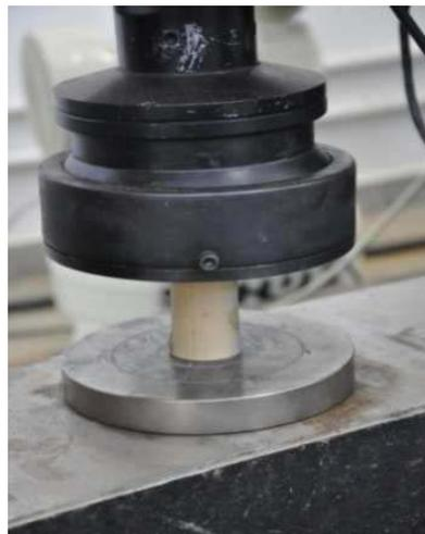
Figura 4.10: Corpo de prova de bambu posicionado na prensa para avaliação da resistência à compressão paralela às fibras.
