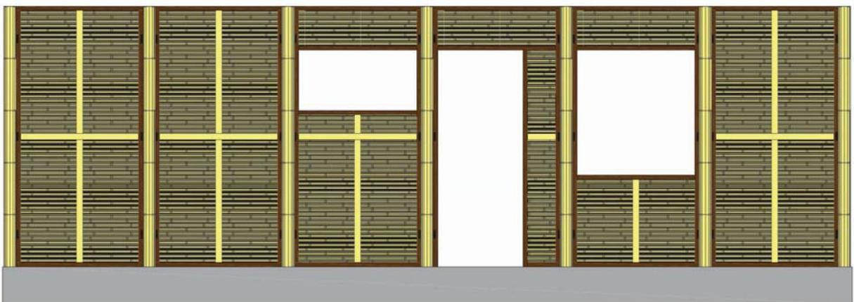
Figura 2.3: Vista frontal dos painéis de bambu utilizados na fachada posterior da habitação.
