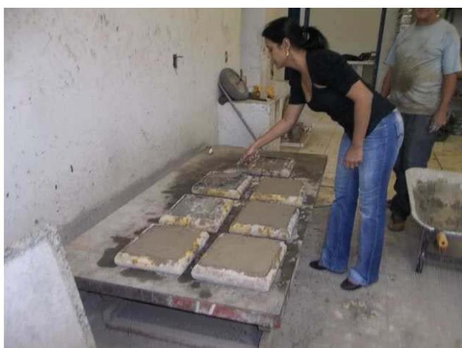
Figura 3.42: Painéis de bambu recém argamassados, sendo vibrados na mesa vibratória.
