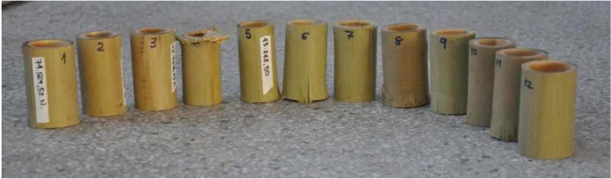
Figura 4.11: Corpos-de-prova de bambu sem nós, após o ensaio de compressão.
