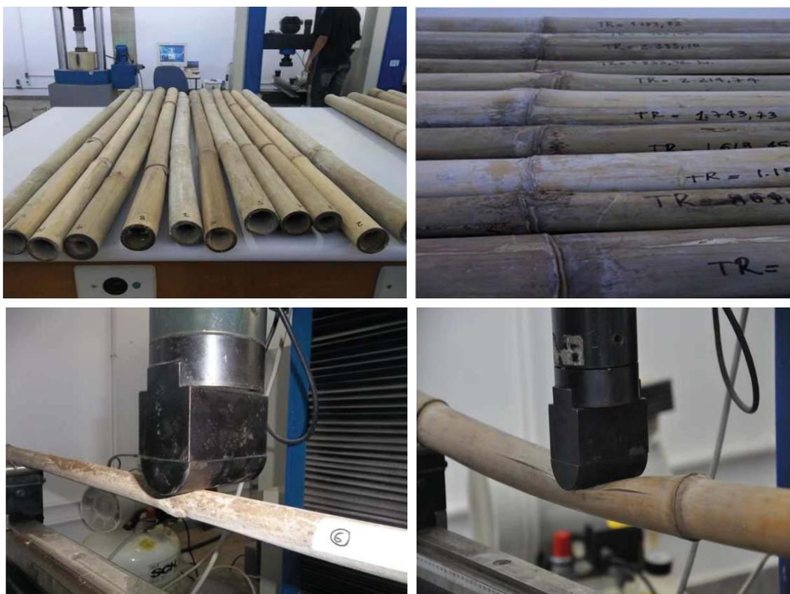
Figura 4.13: Corpos de prova de bambus naturais, utilizados no ensaio de flexão perpendicular às fibras.
