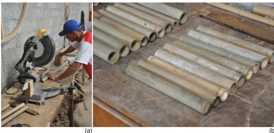
Figura 3.25: Corte das varas de fechamento com o auxílio de serra elétrica (a); Peças de *Bambusa tuldooides* já cortadas, preparadas para a montagem do painel (b).
