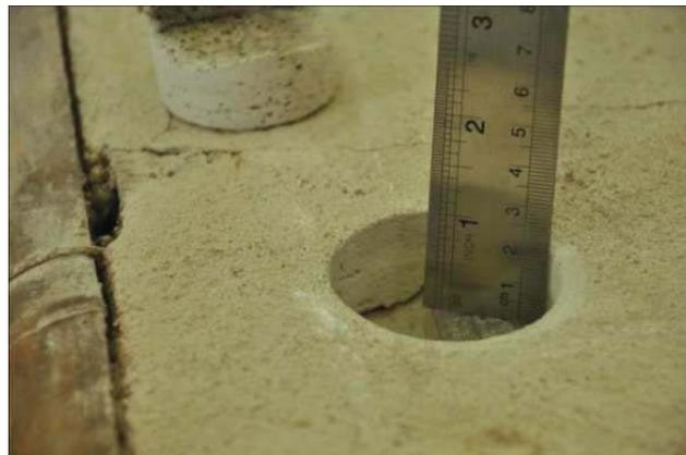
Figura 4.23: Medição da argamassa de revestimento, com régua metálica, sobre a vara de bambu.
