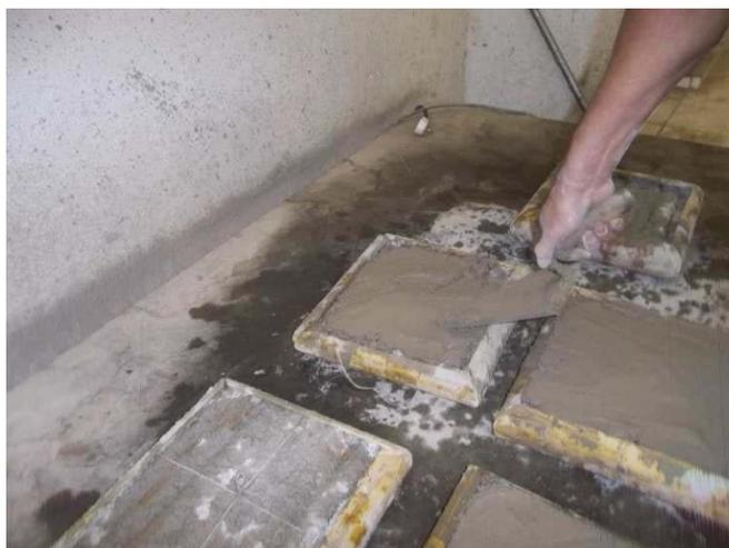
Figura 3.41: Aplicação da argamassa de revestimento nos painéis de bambu.
