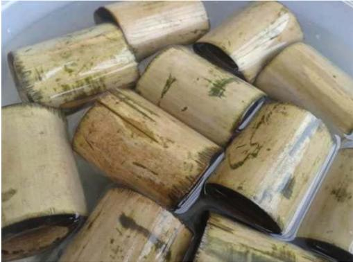
Figura 4.5: Corpos de prova imersos em recipiente com água, para avaliação da umidade de saturação dos bambus *in natura*.
