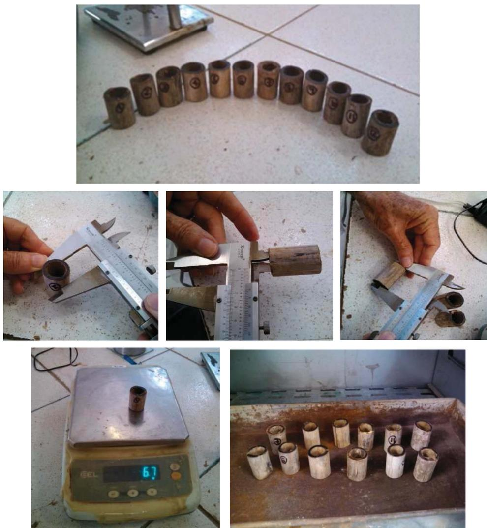
Figura 4.34: Realização do ensaio de densidade dos bambus envelhecidos naturalmente.
