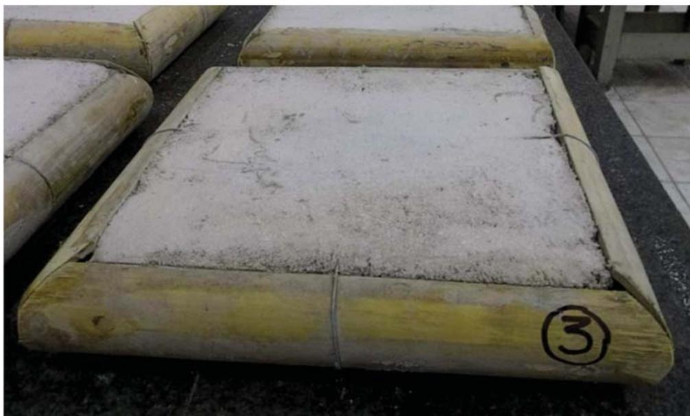
Figura 4.47: Análise visual da argamassa de revestimento no corpo de prova nº 3, após o ensaio de envelhecimento acelerado.
