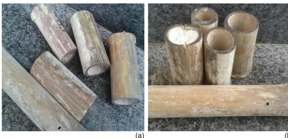
Figura 4.17 (a) e (b): Aparência dos bambus mineralizados, retirados do interior dos painéis não envelhecidos.
