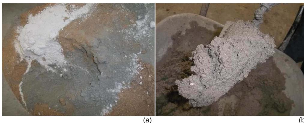
Figura 3.40: Materiais componentes da argamassa de revestimento como cal hidratada, cimento e areia artificial média (a); e aspecto da argamassa de revestimento no estado fresco (b).
