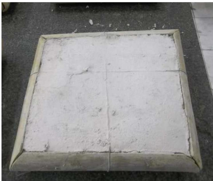
Figura 4.14: Aspecto visual da argamassa de revestimento aplicada ao painel não submetido a processos de envelhecimento.
