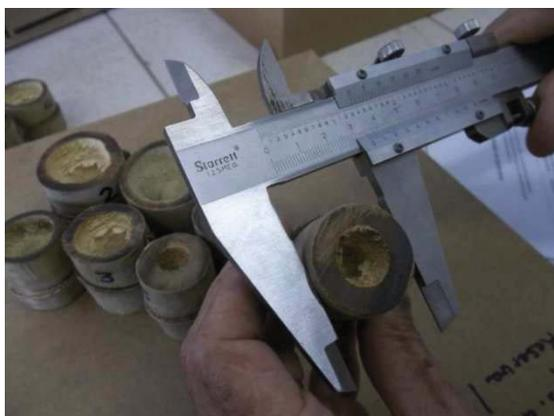
Figura 4.52: Corpos de prova de bambu envelhecidos de forma acelerada, sendo medidos com o uso de paquímetro manual.
