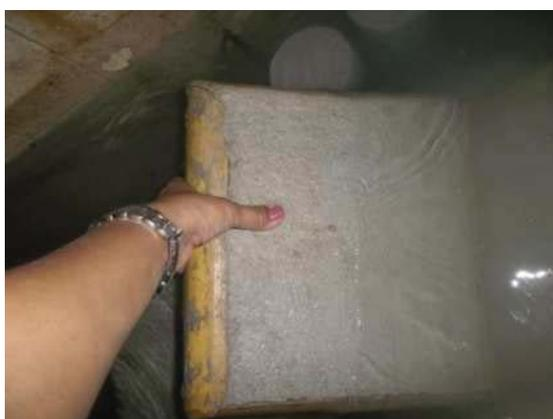
Figura 4.42: Etapa de molhagem dos corpos de prova, durante 24 horas, antes do início dos ciclos de envelhecimento acelerado.
