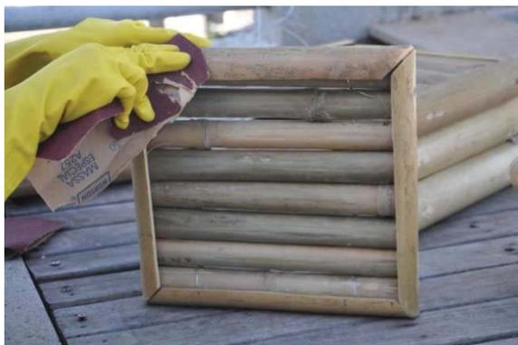
Figura 3.32: Painel de bambu sendo lixado, antes da Mineralização.
