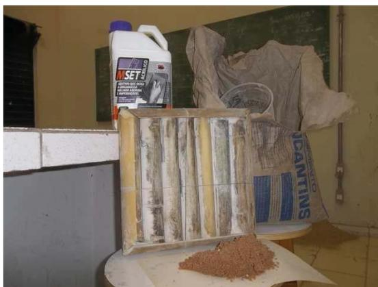
Figura 3.37: Materiais utilizados para a produção da argamassa de chapisco: areia, cimento e adesivo de base acrílica.
