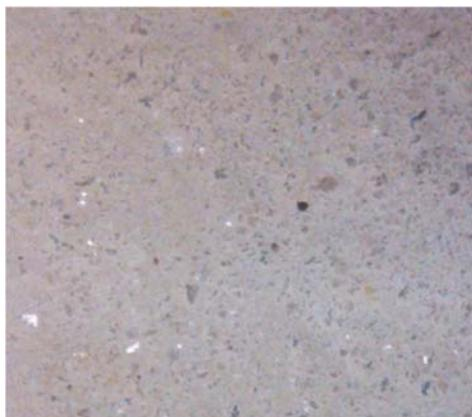
Figura 3.45: Detalhe aumentado do aspecto visual da argamassa de revestimento aplicada aos painéis de bambu.
