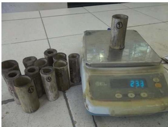
Figura 4.51: Avaliação da massa dos corpos de prova de bambu envelhecidos de forma acelerada.
