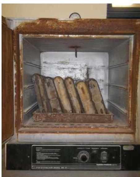
Figura 4.44: Secagem dos corpos de prova de bambu em estufa.
