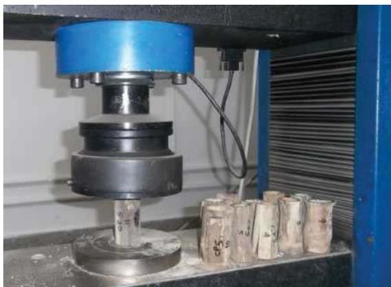
Figura 4.55: Corpos de prova envelhecidos de forma acelerada utilizados para o ensaio de compressão paralela às fibras.
