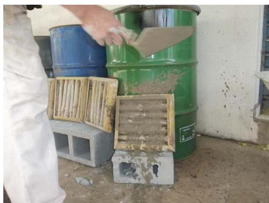
Figura 3.38: Lançamento do chapisco às estruturas de bambu.
