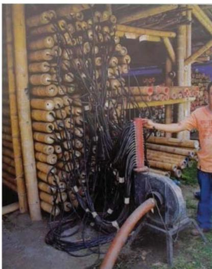
Figura 1.11: Tratamento dos colmos de bambu sob pressão.
