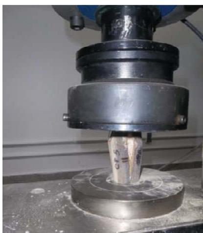
Figura 4.56: Ensaio de compressão paralela às fibras sendo realizado em corpos de prova envelhecido de forma acelerada.
