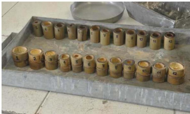
Figura 4.4: Corpos de prova extraídos da parte mediana do colmo, após secagem em estufa, preparados para realização dos ensaios de umidade.
