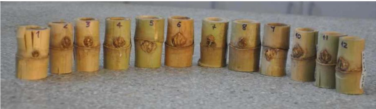
Figura 4.12: Corpos-de-prova de bambu com nós, após o ensaio de compressão.
