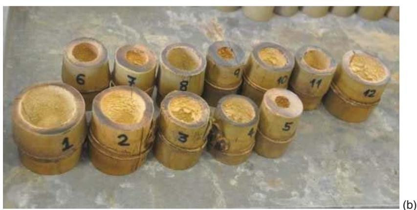
Figura 4.7: Amostras utilizadas para a avaliação da densidade dos bambus *in natura*, secas em estufa, divididas em grupos sem nós (a) e com nós (b).
