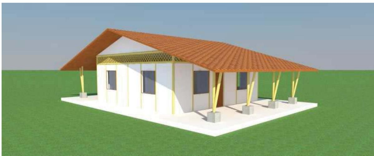
Figura 2.15: Perspectiva volumétrica da habitação econômica, evidenciando o uso dos painéis de bambu.
