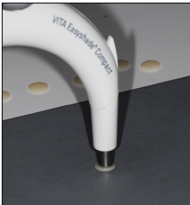
Figura 6: Leitura espectrofotométrica com o espécime posicionado sobre o fundo cinza
