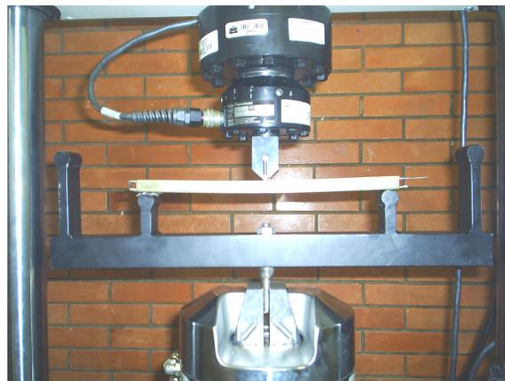
Figura 4.57 – Ensaio de flexão do CP12 a  $25\text{ }^{\circ}\text{C} < M_f$  para o vão  $L=280$  mm.
