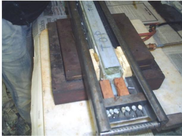
Figura 4.19 – Bancada de fabricação de vigas híbridas sobre a placa térmica.
