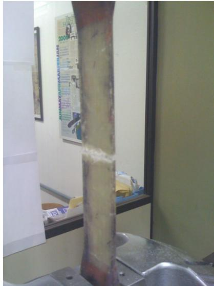
Figura 4.52 – CP02, com oito fios de arame, a 25 °C, rompido por tração.
