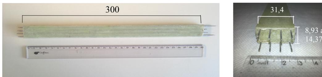
Figura 4.35 – As dimensões médias (em mm) de vigas SMAHC.
