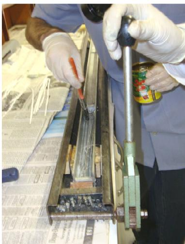
Figura 4.16 – Fabricação de vigas compósitas híbridas com tiras de mantas isotrópicas de vidro-E e fios, ambos impregnados com epóxi de cura a frio.
