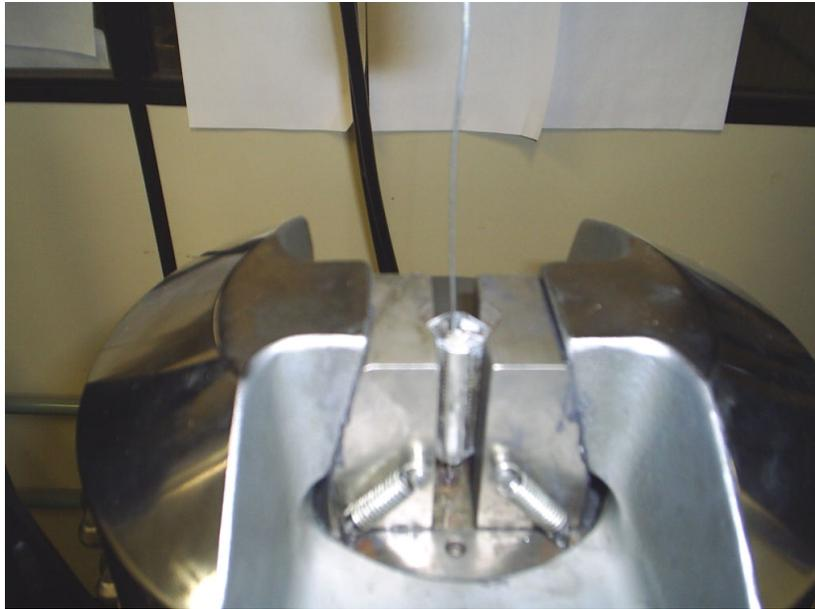
Figura 4.40 – CP02 de fio (Ni-Ti) submetido à ruptura por tração a  $25\text{ }^{\circ}\text{C} < M_f$ .
