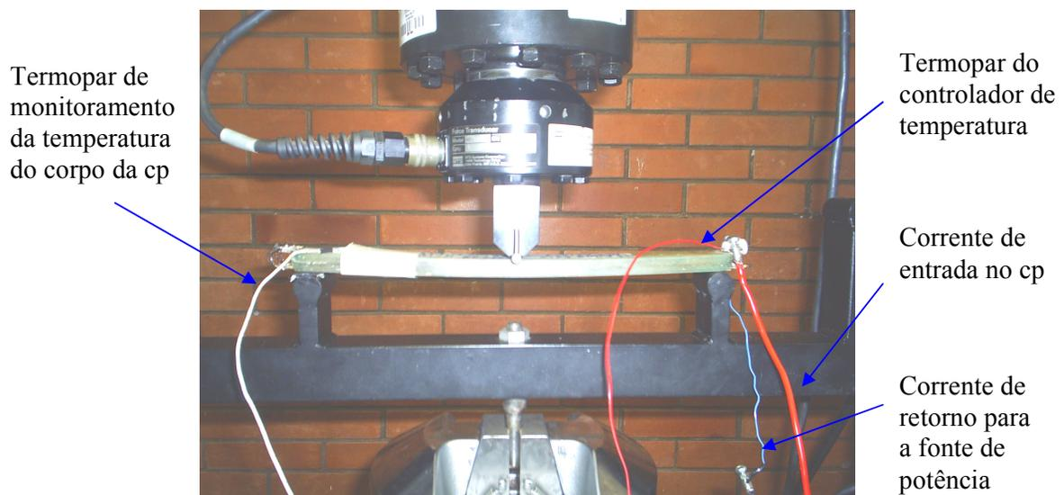
Figura 4.58 – Ensaio de flexão do CP11 a  $69\text{ }^{\circ}\text{C} > A_f$  para o vão  $L=280$  mm.
