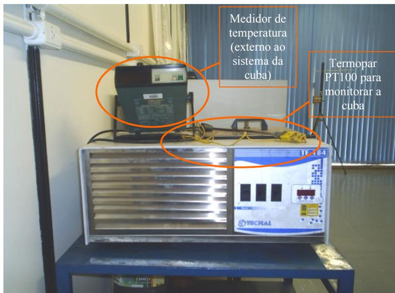
Figura 4.50 – Sistema de aquecimento e resfriamento controlado para determinação da resistência elétrica em função da temperatura da liga de Ni-Ti (55,49% de Ni).
