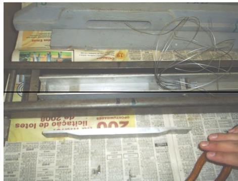
Figura 4.25 – Cavalete de alumínio aparafusado no sulco do molde fêmea que permite confeccionar os *tabs* embutidos nas barras de até oito fios.
