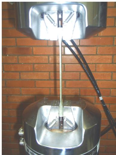
Figura 4.53 – CP03, com oito fios de Ni-Ti, sob tração até a ruptura a 25 °C.
