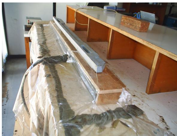
Figura 4.18 – Processo com bolsa de vácuo a frio para cp's.
