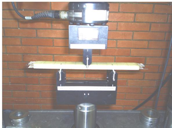
Figura 4.56 – Ensaio de flexão a  $25$ °C do CP12 (SMAHC) para o vão  $L= 150$  mm
