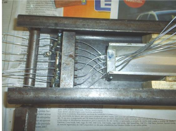
Figura 4.13 – Passagem dos quatro fios da camada de fundo do molde pelo eixo de estiramento e os quatro fios da camada superior livres do dispositivo nesta etapa.
