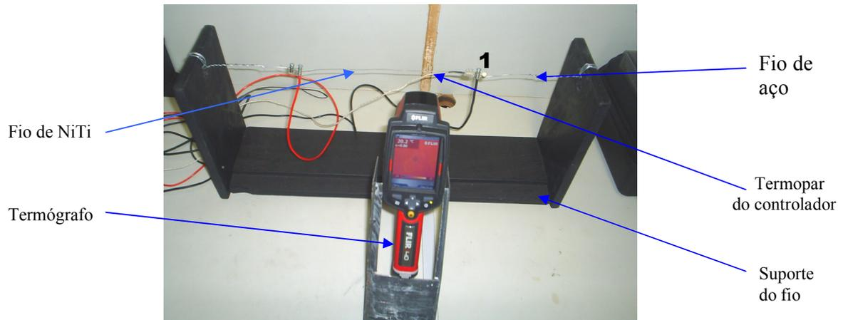
Figura 4.46 – Bancada para medida da temperatura por termografia do fio de Ni-Ti.
