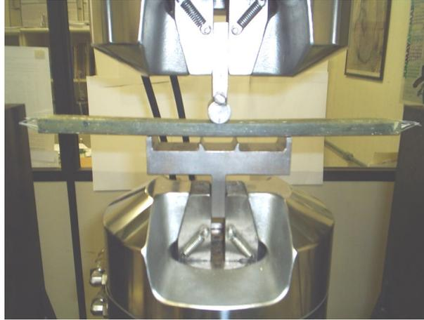
Figura 4.55 – Ensaio de flexão a  $25$  °C do CP08 para o vão  $L= 114$  mm.
