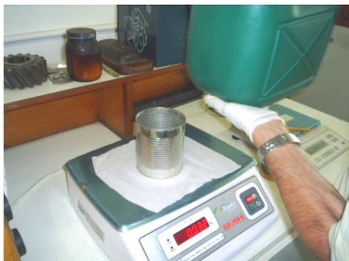
Figura 4.15 – Balança digital para pesar os fios metálicos, mantas de vidro-E e o epóxi.
