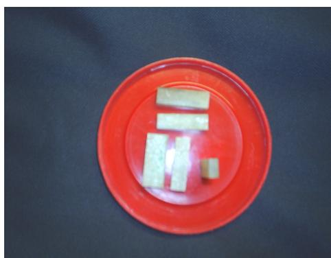
Figura 4.60 – Amostras prismáticas de vigas de vidro-E/epóxi/fios de Ni-Ti.
